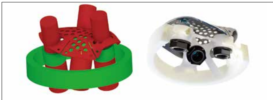
自动设计用于颅骨板的 Blue Photon 夹具的工作流程。创成式设计工作区 (Autodesk Fusion 360) 显示绿色保护区和红色障碍几何体。这个过程不需要专业的 CAD 设计时间，并将自动进行优化，以便在应用的加工负荷下实现最大的刚度。
