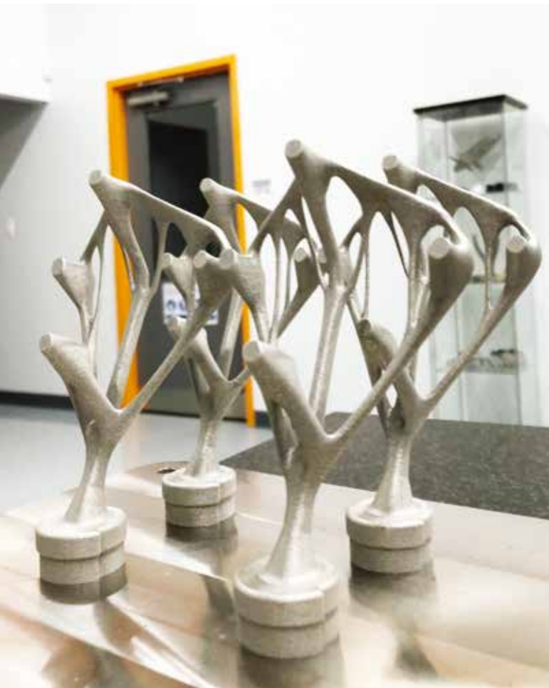
位于安大略省 Kitchener 市的 Renishaw 公司加拿大解决方案中心，在进行 CNC 精加工之前，加工托盘上的钛合金髋关节跟踪器原型。（所有图片均由 Renishaw 加拿大公司提供）
