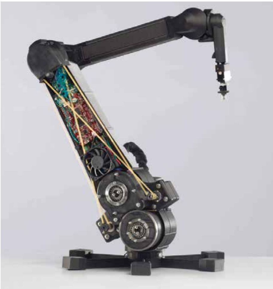
Haddington Dynamics 公司通过在 MarkForged 机器上打印大部分零件，将成本降低了 58%，并将其机械臂上的零件数量从 800 个减少到不足 70 个。此外，该公司通过用连续的碳纤维长丝材料进行加固，提升了其刚度。最终，该手臂实现了 50 微米的运动精度。（图片由 Markforged 提供）
