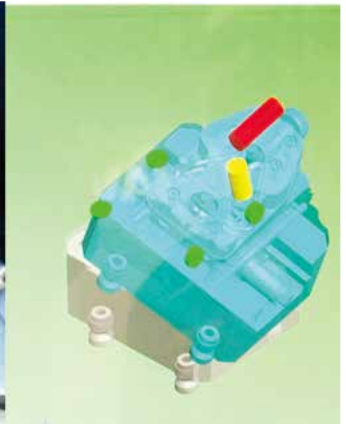
塑料保形卡爪和 CNC 探测后由 NC-PerfectPart 软件进行的最佳拟合坐标转换。
