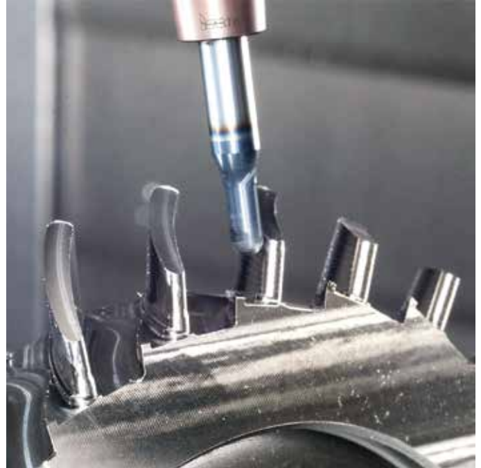
图4：安装在热缩夹头中的多刃整体硬质合金立铣刀对一个整体叶盘进行摆线粗铣。
