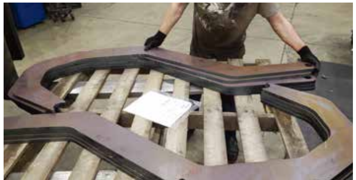
凭借其新型激光切割机，EIMCo 可以更高的速度切割厚度达 1" (25.4-mm) 的板材。
