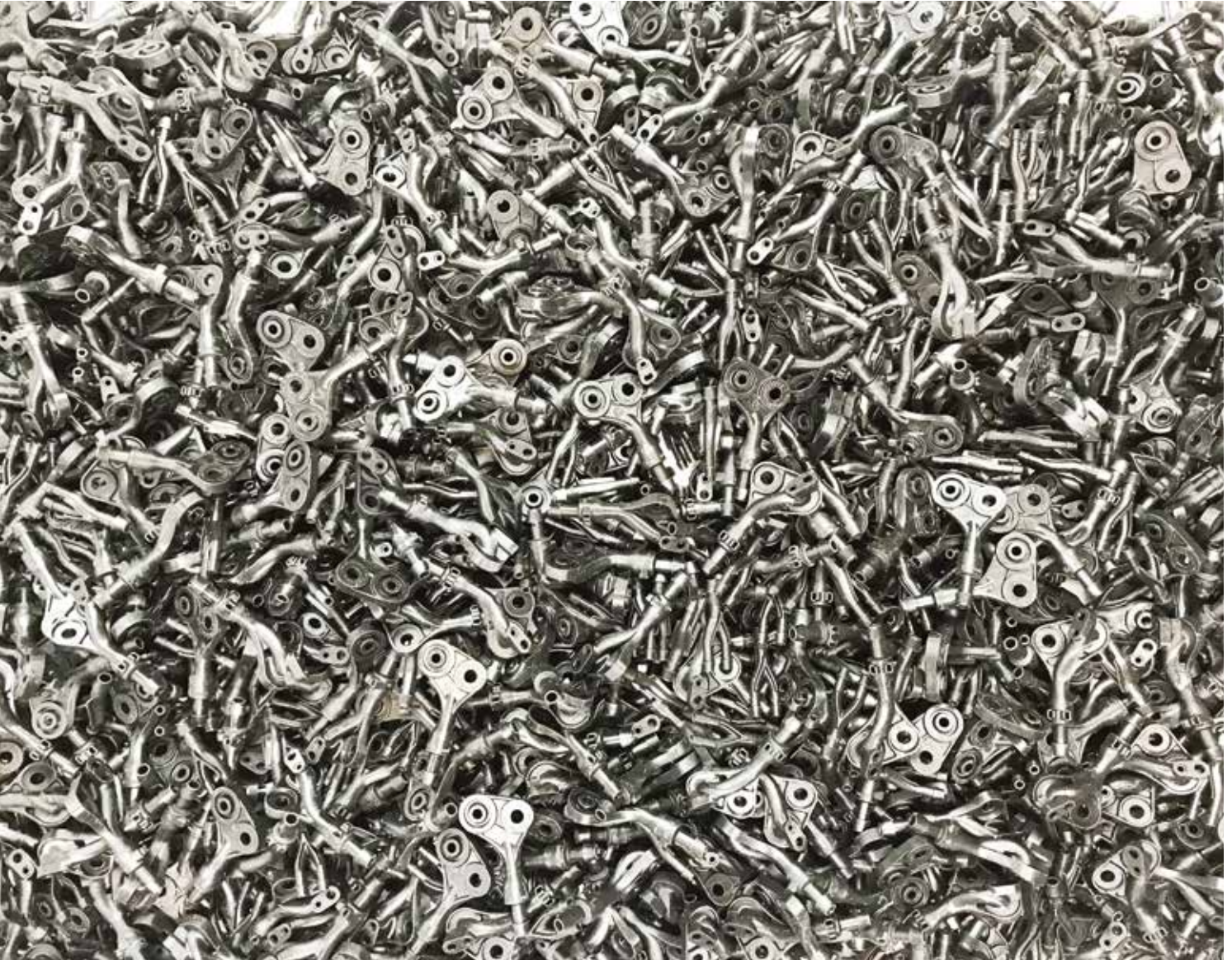
通过使用 3D Systems 的 Figure 4 Production Black 10 新型感光材料，一个 DLP 引擎在 48 小时内生产了这 1200 个塑料成品工件。（图片由 3D Systems 提供）
