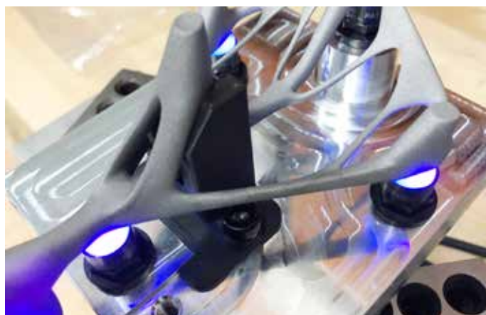
使用紫外线将髋关节跟踪器粘合到 Blue Photon 夹具上。该解决方案可以牢固地固定零件，且不会因塑料夹爪的夹紧力而导致变形。
