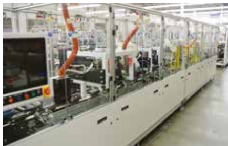
Owens Design 公司的全自动装配线。公司的许多客户专注于医疗诊断设备，设备需要消耗性组件，其中主要是用于测试的灌流器。Owens 公司帮助客户管理他们不断扩大的生产需求。(图由 Owens Design 公司提供)
