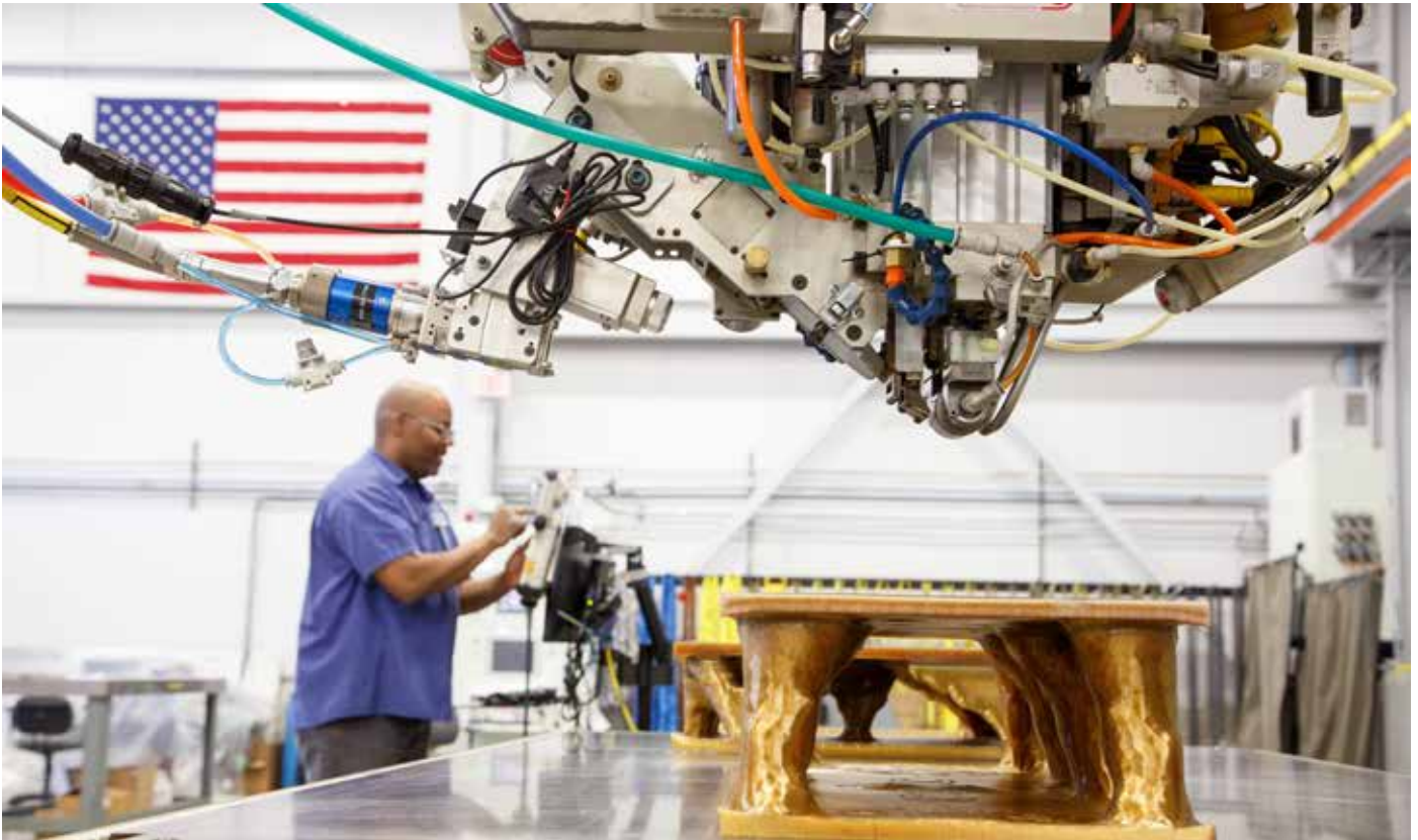
Automated Dynamics 公司的原位固结的动态过程利用挤压流动造成剪切变薄和混合，使聚合物链纠缠在一起，使层与层牢固的结合。
