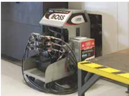
Vektek 最新的高级工件夹具泵可以集成到 CNC 中，并直接通过机器控制器来操作夹具。（图片由 Vektek 提供）
