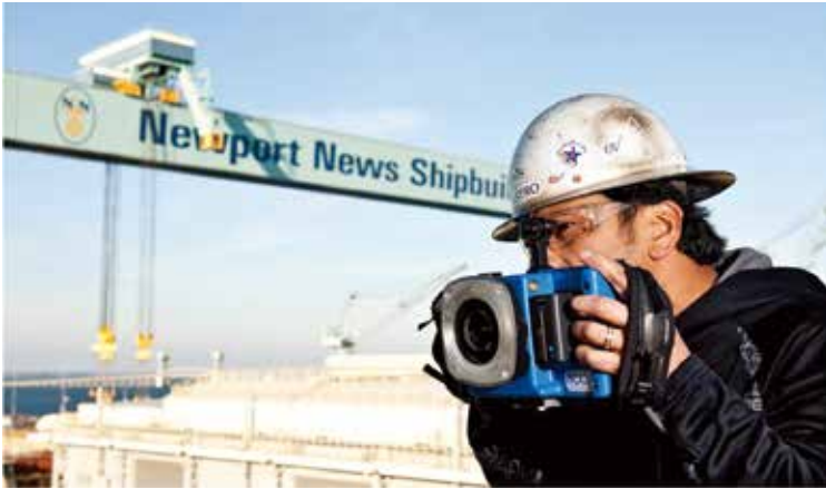
摄影测量是 Newport News Shipbuilding 和其他大型零件和组件制造商常用的一种测量技术。
