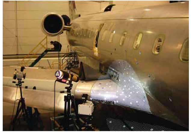
便携式自动摄影测量系统可用于从飞机到发电等行业的非接触、高精度的 3D 坐标测量。
