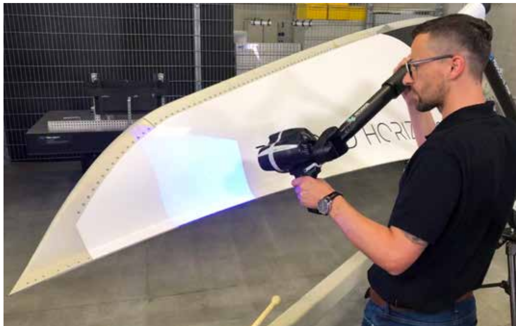
海克斯康公司 RS-SQUARED 三维白光扫描仪使用一个铰接式的七轴测量臂来定位大型方形“瓦片”的三维扫描数据。每秒钟最多可以采集四块“瓦片”。(图片由海克斯康公司提供)
