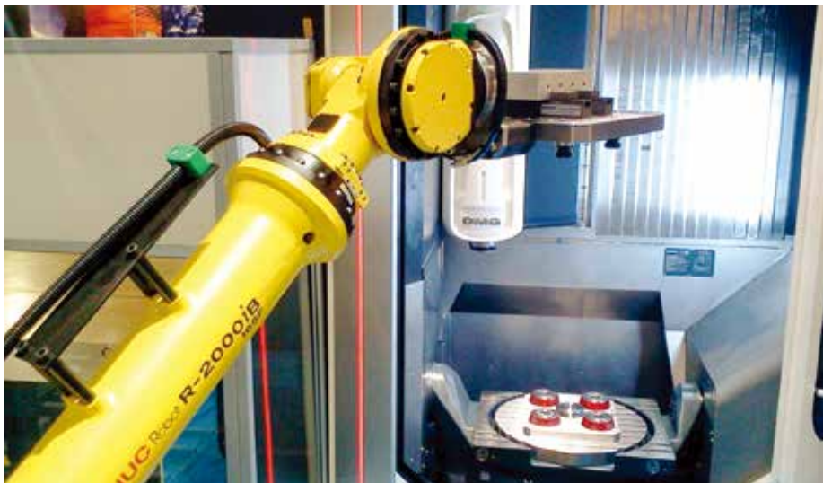
通过使用零位夹持系统，夹具和托盘的机器人装 / 卸载变得更加简单——图中为安装了 BIG Kaiser 的 UNILOCK 系统。(图片由 BIG Kaiser 提供)
