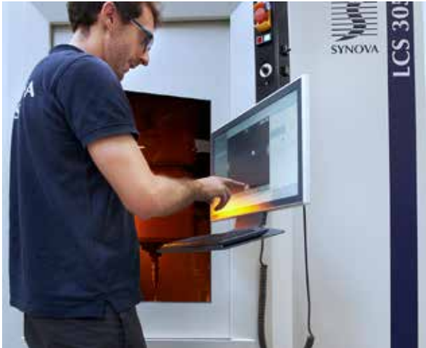
Synova 公司的 Laser MicroJet 工艺使用水流来控制 Nd:YAG 激光器的光束，并使其保持为圆柱形。
