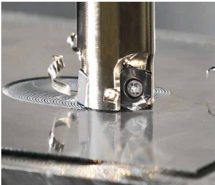
Kyocera 的螺旋式 MFH 铣刀旨在以较低的切削力，实现高进给和高金属去除率。（图片由 Kyocera Precision Tools 提供）
