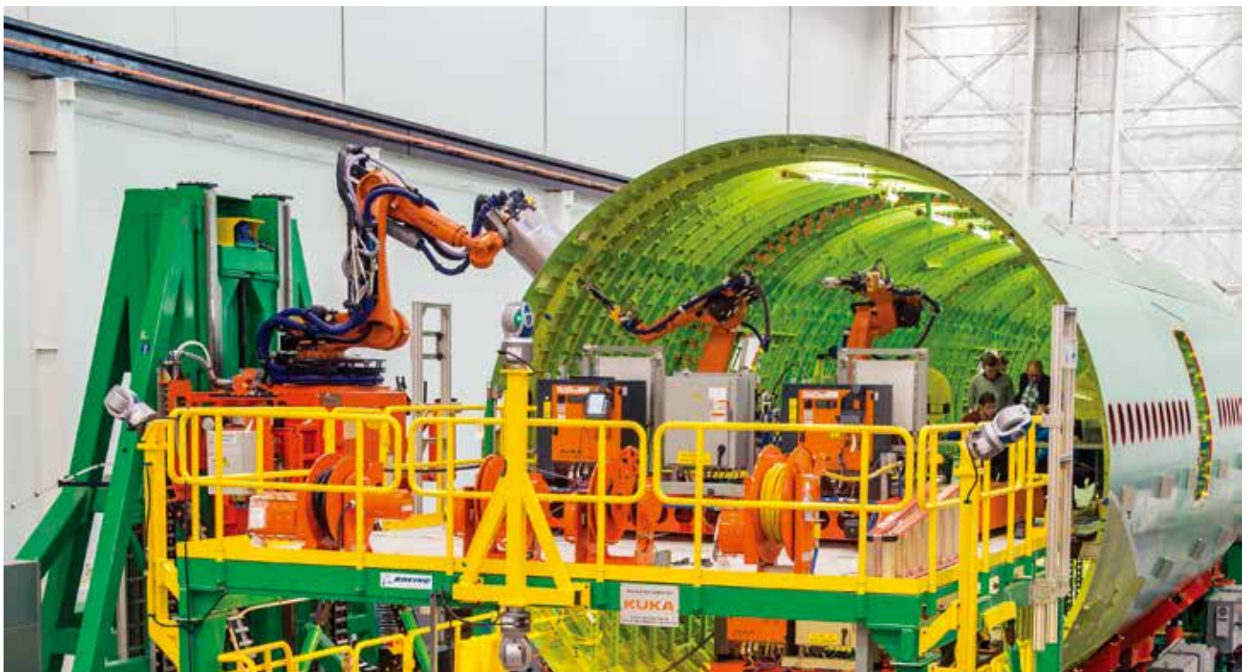
激光跟踪器在 Boeing 公司的 FAUB（机身自动直立制造）项目中捕捉尺寸数据。
