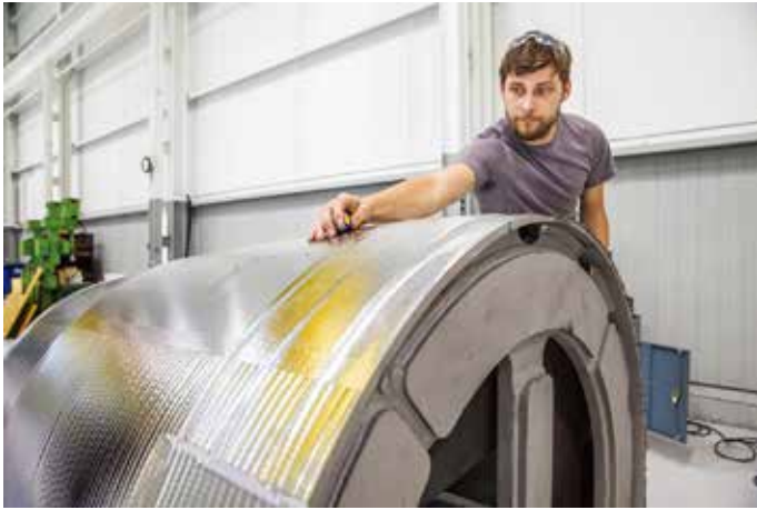
在 Service Mold + Aerospace 公司，用 Zimmermann 五轴加工中心精加工铝制模具。
