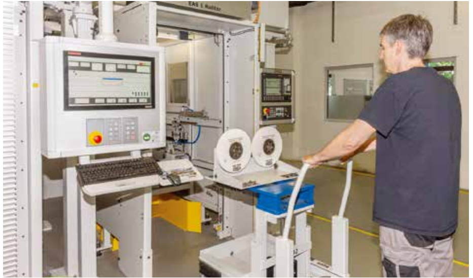
工人正在为四个平行操作的六轴全自动研磨加工单元准备砂轮。
