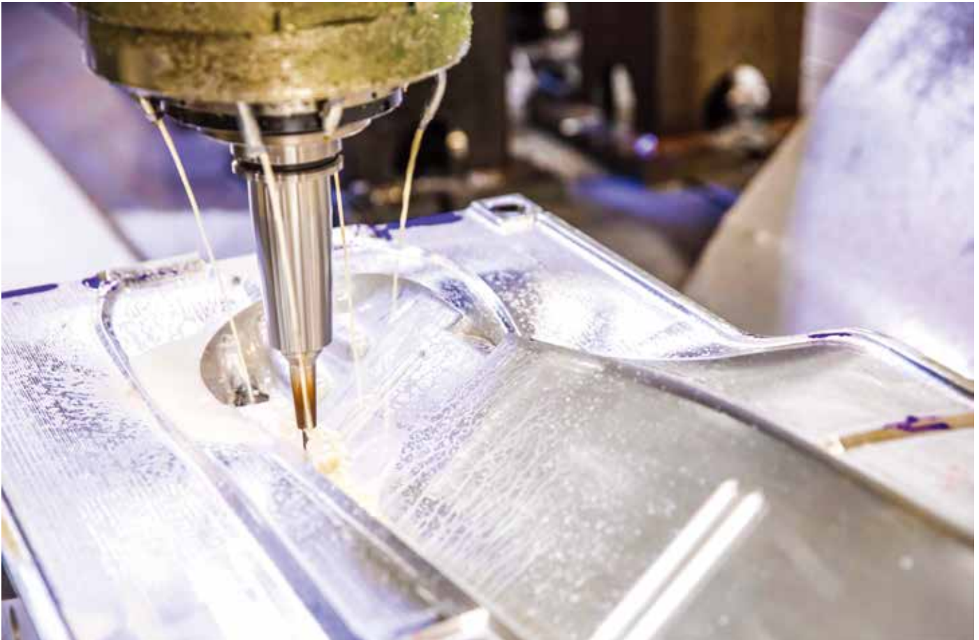
Service Mold + Aerospace 公司使用一台大型的 Zimmermann 龙门式五轴机床对钢制零件进行精加工。
