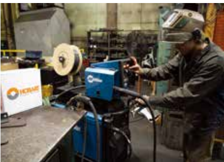
Miller Electric 公司的 Deltaweld 350 MIG 焊机使 Webster 公司的焊接操作员能够在普通 MIG 和脉冲 MIG 焊接之间轻松切换。
