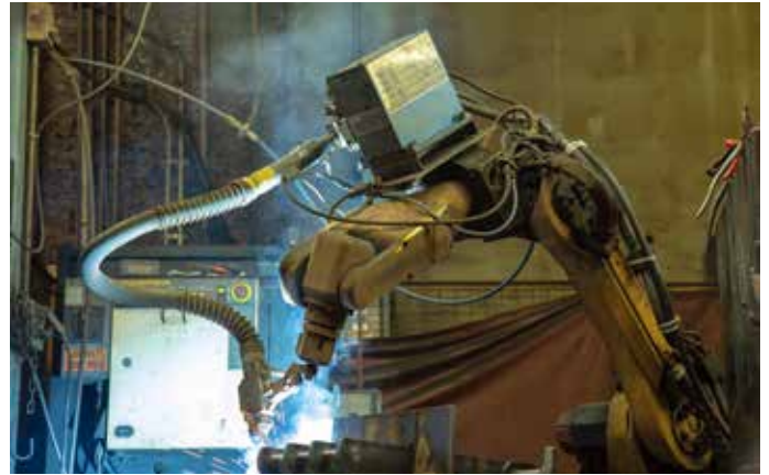
改用金属芯焊丝后，Webster Industries 公司的焊接作业效率提高了 18-20%。
