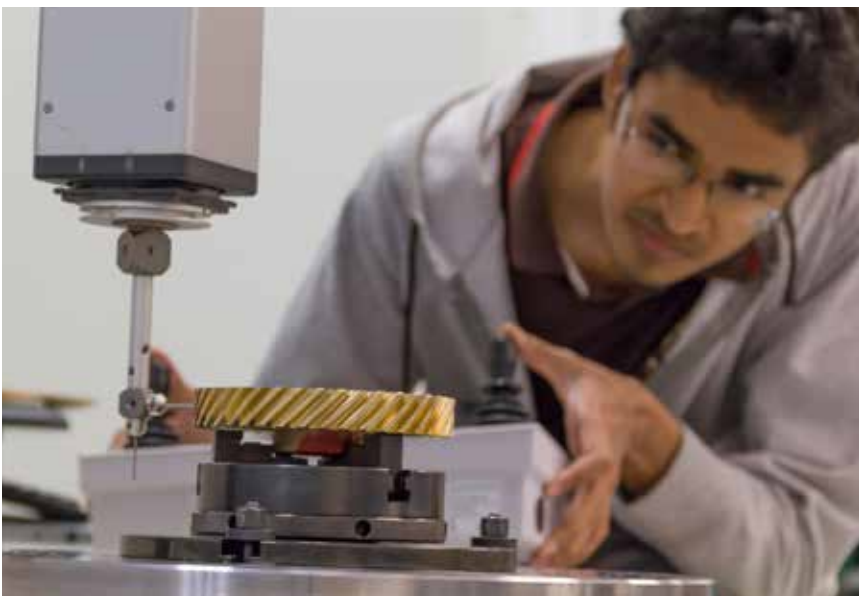
在北卡罗来纳大学夏洛特分校的精密计量中心，一名学生操纵 CMM 控制器，移动一个触摸式测头。(图片由 UNCC 提供)
