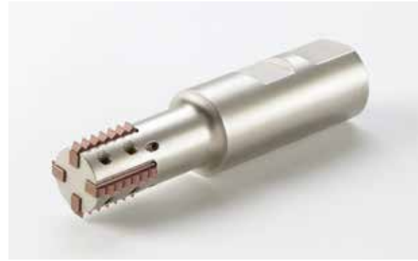
Carmex 公司的 Slim MT 系列具有新的纳米涂层，所承受的加工温度比 TiAlN 刀具高 30%，比通常用于可转位刀具的其他涂层适用硬度高 25%。（图片由 Carmex 公司提供）
