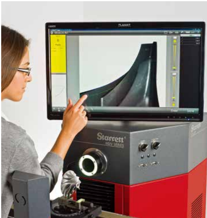
Starrett HDV300 是一款水平式数字视频比较仪，结合了水平式光学比较仪和视觉计量系统的特点。（图片由 L.S. Starrett 公司提供）
