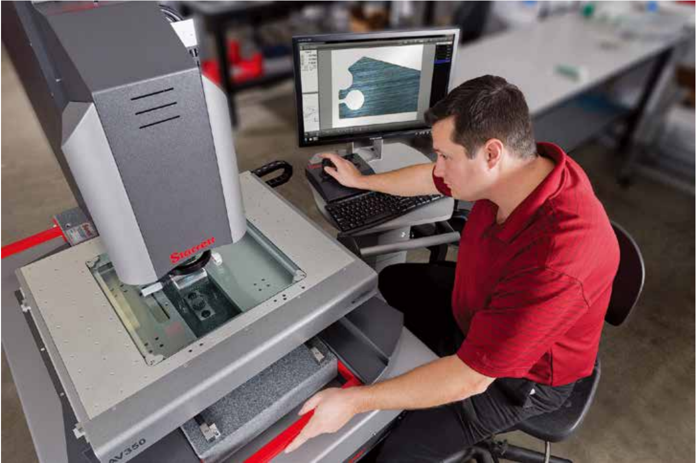
基于视频的 Starrett AV350 CNC 视觉系统具有 12:1 的变焦光学系统。(图片由 L.S. Starrett 公司提供)
