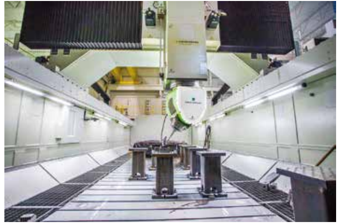
在 Service Mold + Aerospace 公司，激光跟踪器操作员正在扫描一个粗加工的钢制粘合件。
