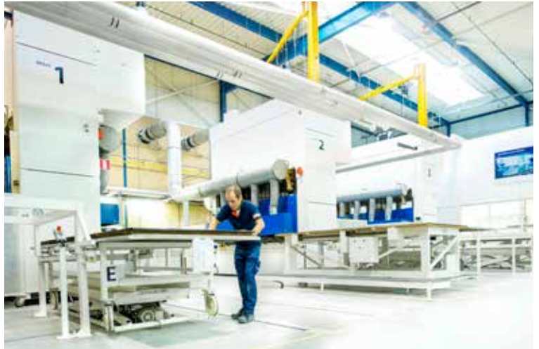
Toray Advanced Composites 公司的 Cetex RTL 板材有多种可定制的纤维和树脂组合，适用于快速热成型，以制造内部和外部航空航天部件。
