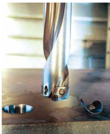
可换头钻头可以为高产量的加工工作提供快速换刀功能，从而显著地降低成本和加工周期时间。
