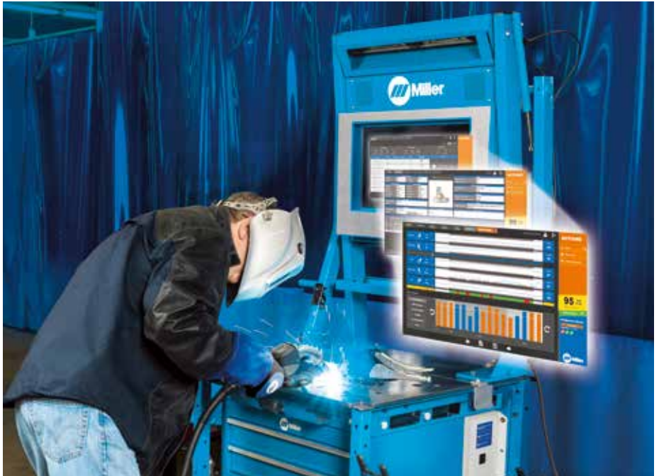
Miller 公司的 LiveArc AR 培训系统在实际焊接过程中 ( 如图所示 ) 和模拟模式下都能为手工焊接者提供准确、实时的工作角度、移动角度、接触点到工作点的距离、移动速度和目标反馈。( 图片由 Miller Electric Mfg 公司提供 )
