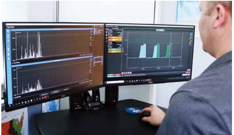
可以远程查看由 TMAC 采集的刀具监测数据。（图片由 Caron Engineering 公司提供）
