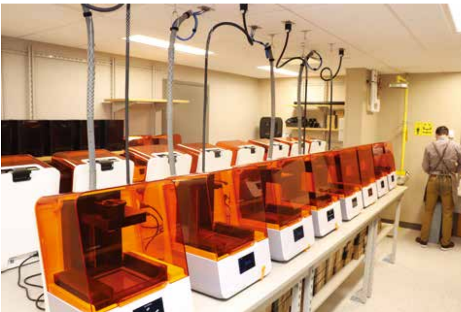
Mayo Clinic 的技术员 Grant Call 在 Formlabs 3B 型还原光聚合打印机上进行光学测试。Mayo 在其团队中增加了 20 台 3B 打印机，用于 3D 打印可进行 COVID-19 测试的手足口中拭子。(图片由 Mayo Clinic 提供)
