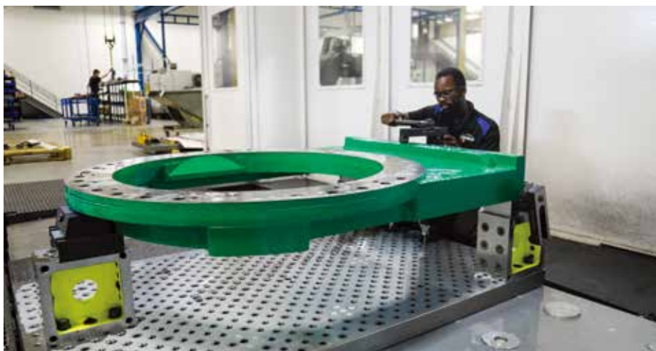
Bluco 公司的客户参观了其 Validation Center，他们可以带上自己的零件并在现场用推荐的夹具加工。在这里，Bluco 公司的一名机械师在一块 2000 磅（907.18 公斤）的圆盘上测试新的特大型系统的夹具。（图片由 Bluco 公司提供）
