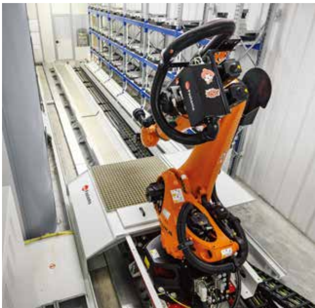
Advanced 的 36 个托盘系统连接到两个 Okuma MU 5000 上，并由 Fastems ROBO-One 柔性制造系统 (FMS) 进行操作。
