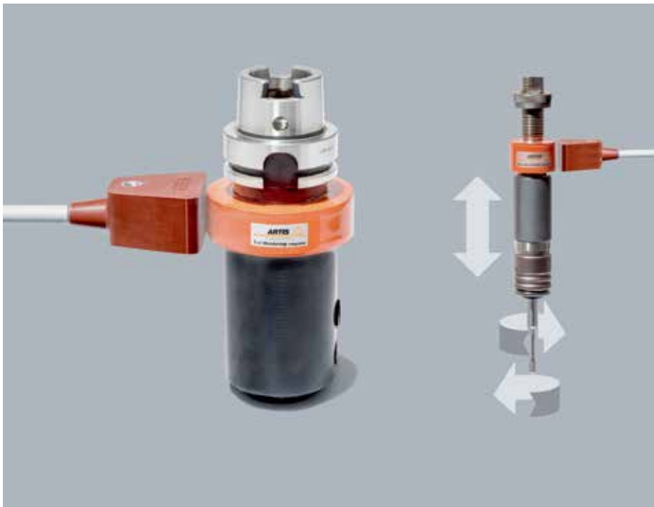
这种 DDU-转子和 DDU-定子传感器系统，可对旋转和刚性刀架进行无接触监测。测量是通过应变片技术完成的。（图片由 Marposs 公司提供）
