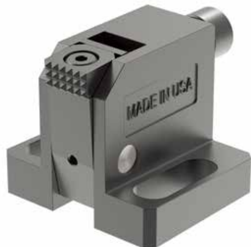
Carr Lane Manufacturing 公司的新型 Pivoting Edge Clamps，可同时向前和向下施加夹持力。钳口有一个可更换的锯齿状夹子，由硬化工具钢制成，具有大力以及耐用性强的特点。（图片由 Carr Lane Manufacturing 公司提供）
