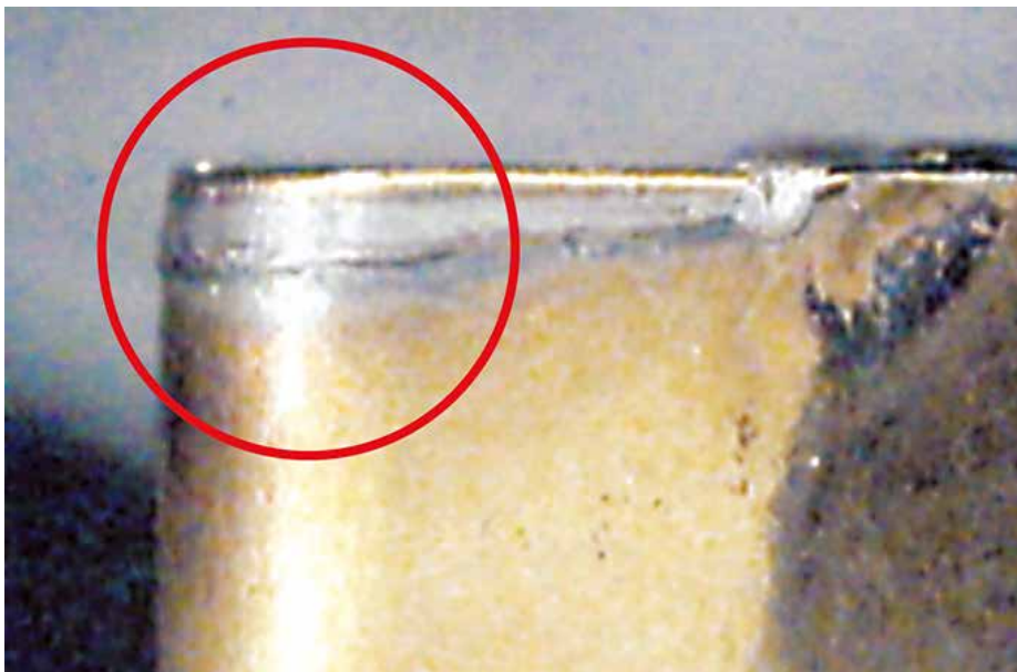
显微镜可用于放大切削刃图像，让用户更好地了解刀刃磨损等问题。 (图片由 Ingersoll Cutting Tools 美国公司提供)
