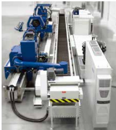
像 UNISIG 这样的深孔钻机 OEMs 会将冷却系统（如图这一系统）以及控制装置纳入到设备的设计中，以确保整合以及性能的一致性。（图片由 UNISIG 公司提供）
