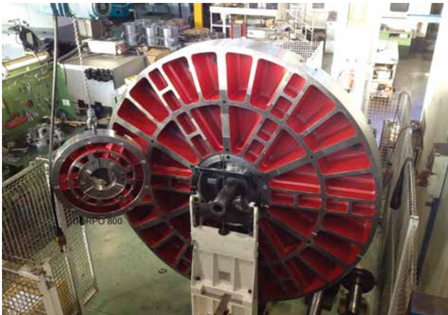
SMW Autoblok 公司为大型工件制造夹具，包括 2,500 毫米的超大 IR-C 卡盘，图示是平衡装置及其“小兄弟”，800 毫米的 IN-C。（图片由 SMW Autoblok 公司提供）
