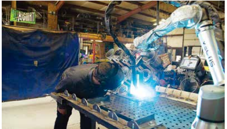
协作机器人很适合做一些比较简单、重复性的工作，这些工作会让人类焊工感到厌烦，而且它们可以在靠近人的地方工作。(图片由 Universal Robots 公司提供)
