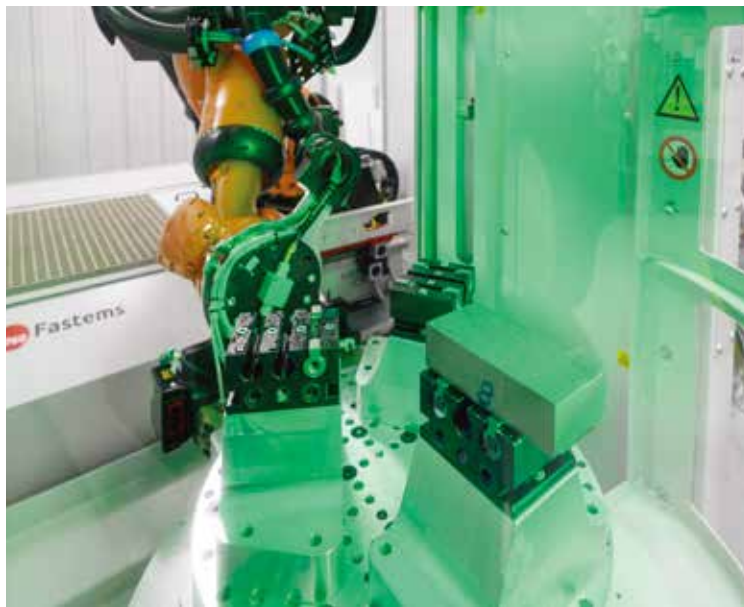
Advanced 通过标准化的工件夹具解决方案，减少了开始加工钛合金航空支架所需的负载转换时间，在信任 Fastems 自动化后，人们立刻看到了主轴利用率的提高。
