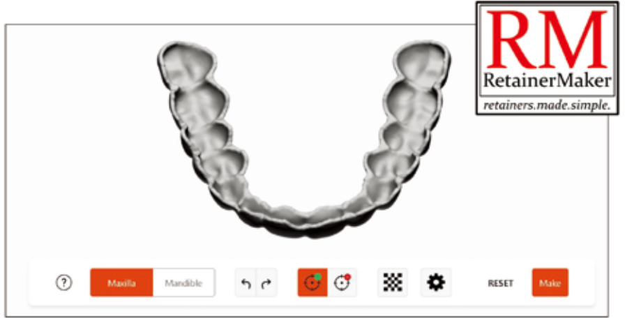
RetainerMaker 软件展示了一个直接可用于终端保持器的 .stl 设计文件。(图片由 Perry Jones 博士提供)
