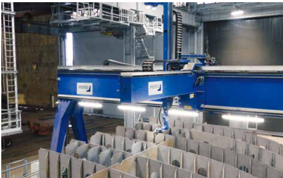
Pemamek 公司的软件和视觉系统可以从远处对焊接进行编程，例如这个非常大的零件，该系统包括对焊接体积的实时激光扫描，以便对整个过程进行监控。( 图片由 Pemamek 公司提供 )
