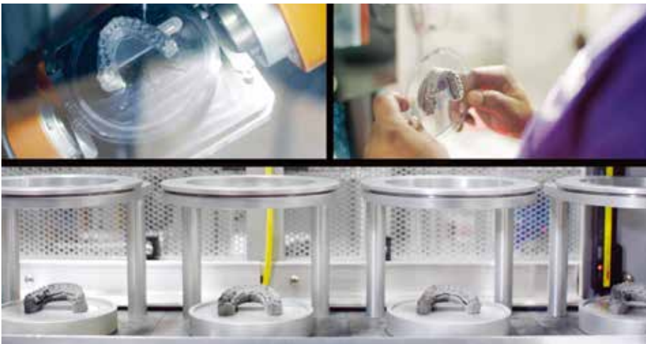
总部位于田纳西州 Nashville 的 SmileDirectClub 已经部署了几十套 HPJet Fusion 3D 打印系统，每天能够生产超过 50,000 个独特的口部移行。（图片由 HP 公司提供）
