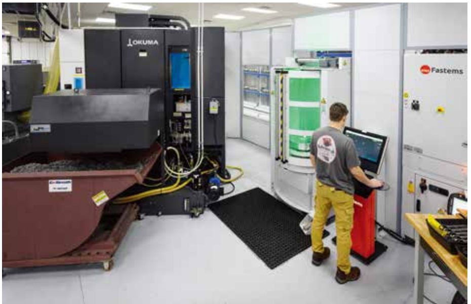
Advanced 使用 Fastems ROBO-One 柔性制造系统（FMS）。通过 MMS7 控制器的调度、预测、数据收集和文件控制等功能，在前端将新系统益处运用的淋漓尽致。（所有图片均由 Advanced 和 Fastems 提供）
