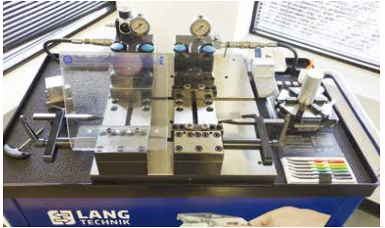
Lang Technovation 公司的封闭技术 Makro-Grip 系列，允许高达 20 吨的液压在工件上冲压出高达 45 HRC 的压痕，以配合夹钳的抓取锯齿。(图片由 Lang Technovation 公司提供)
