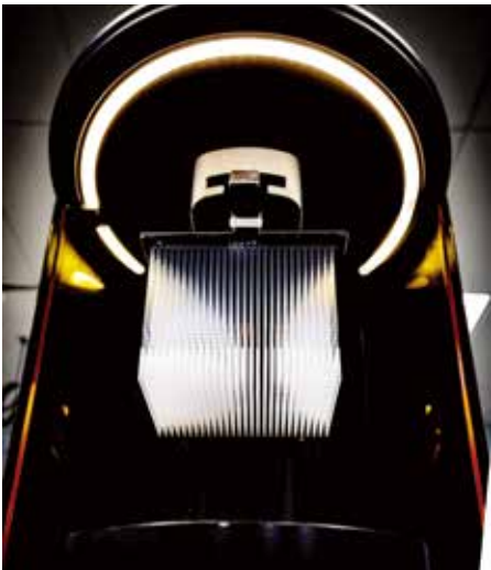
这些鼻咽拭子是用 Carbon 公司的数字光合成 (DLS) 技术开发的，该产品使用了柔软的柔性材料，使病人感到舒适。(图片由 Carbon 公司提供)
