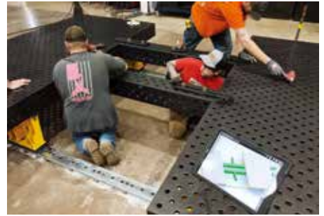
Bluco 公司为 Fairbanks Morse 公司提供的五个工作台解决方案具有专门的组件套件，能够固定九个不同的零件。（图片由 Fairbanks Morse 和 Bluco 提供）
