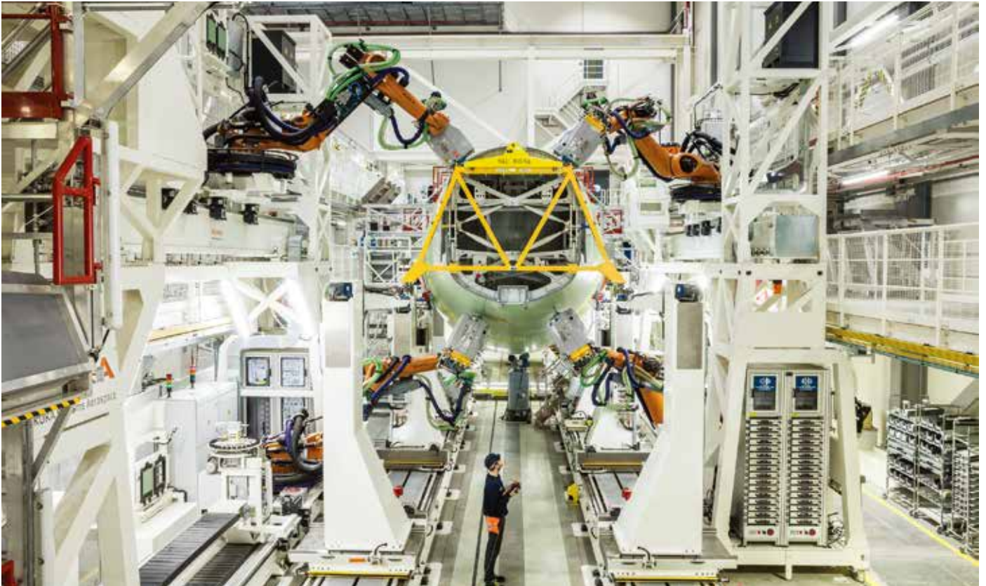
空客公司去年在德国汉堡部署了其 A320 系列机身结构高度自动化装配线。(图片由空客公司提供)
