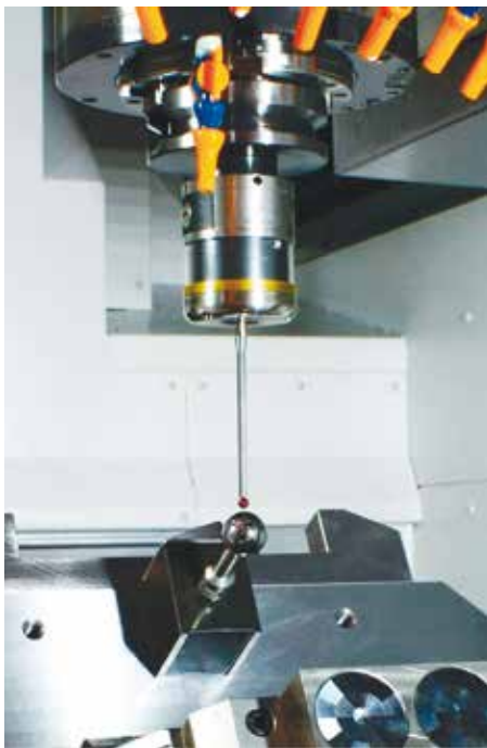
自动调谐只是将专用五轴加工中心与三轴加工中心区分开来的机床选项之一。 (图片由 Okuma 美国提供)
