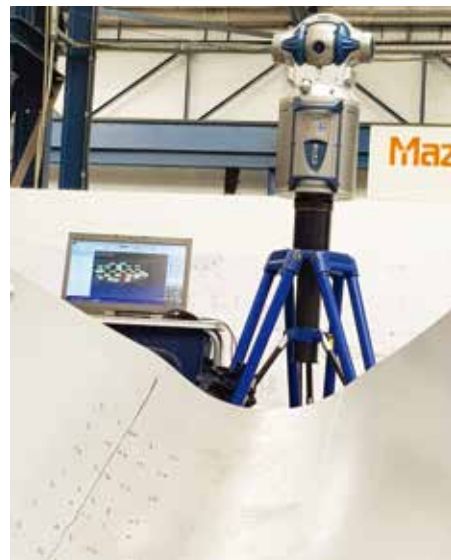
Verisurf Build，也被称为虚拟量具，在坐标测量机激光跟踪器或测头移动后可以显示实时偏差，检测与名义 CAD 模型有关的零件。 (图片由 Hockley 公司提供)
