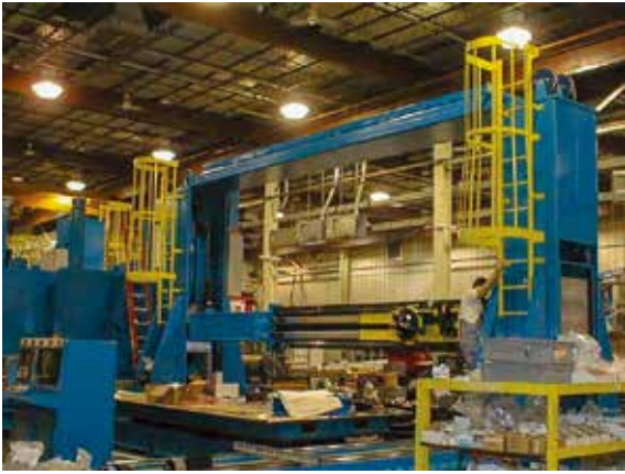
JR 自动化公司在 CNC 控制架构的基础上定制设计了一个六轴龙门式机械手，用于制作发动机罩上的穿孔外壳。(图片由 JR 自动化公司提供)
