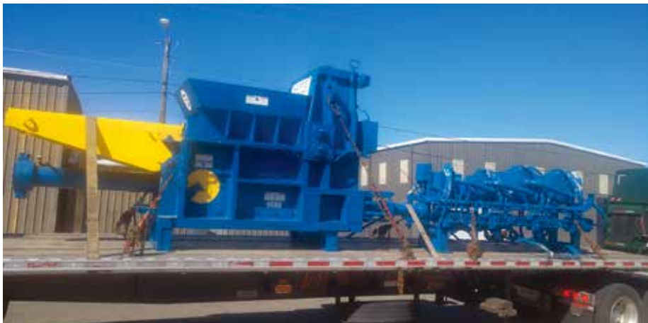
Harris Equipment 在生产回收产品，如这个纸板打包机时，需要在 Hardox 450 钢（硬度 45 HRC）制成的极其耐用的耐磨板衬里上进行攻丝。
