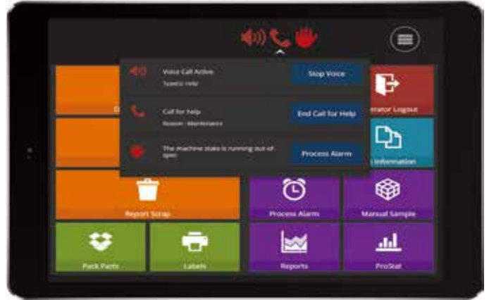
任何制造执行系统 (MES) 的主要功能之一, 都包括在机器出现故障时通知车间人员。(图片由 Epicor 提供)
