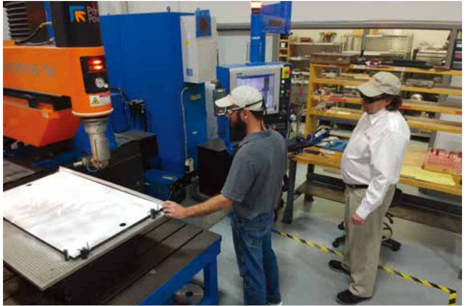
Robert Kissiday 和 Michael Grantham 在他们旁边的 Laserdyne 795 系统中完成一个大型零件的加工设置。在铣削至所需高度后，光纤激光系统正在修整 0.050 英寸不锈钢航空发动机排气部件的成型法兰。
