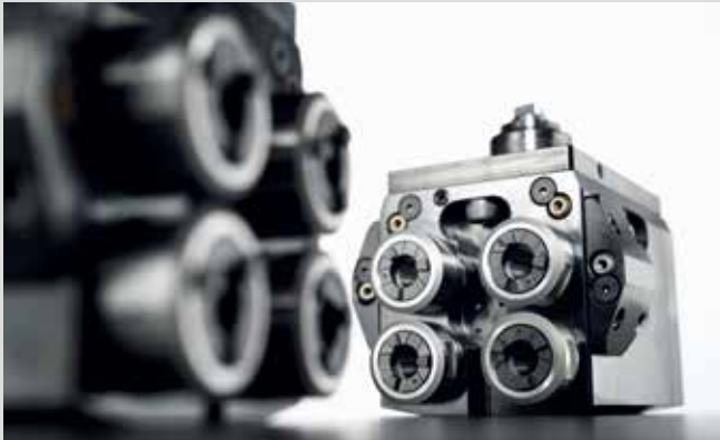
越来越多地制造商要求车床配备活动刀具，包括用于数据监测的传感器，以及配备如图所示的多个主轴。（图片由 Platinum Tooling 公司提供）
