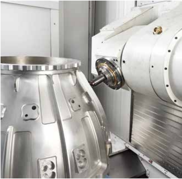
Doosan 集团的新型 DHF 8000 ST 五轴 HMC 配备直接驱动旋转台，旋转速度可达 600 rpm，适用于车削操作。（图片由 Doosan 集团美国公司提供）
