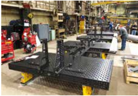
新的 Bluco 解决方案是在 Bluco 工程师的帮助下使用 CAD 模型组装的。它包括五张桌子和 12 米长的地板导轨。（图片由 Fairbanks Morse 和 Bluco 提供）
