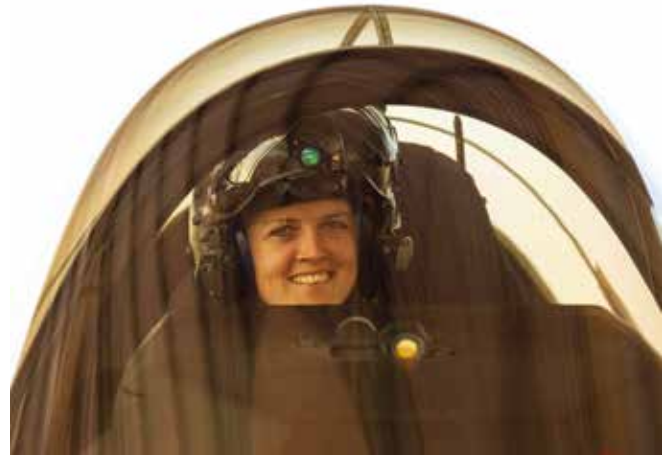
机舱盖的构造可以承受 4lb 重的鸟儿以 480 海里的速度撞击加固的挡风玻璃和以 350 海里的速度撞击天幕顶盖而不破裂。特殊的涂层被应用到成品的机舱盖上，以保持低可察觉性或隐身特性。(图片由美国空军提供)
