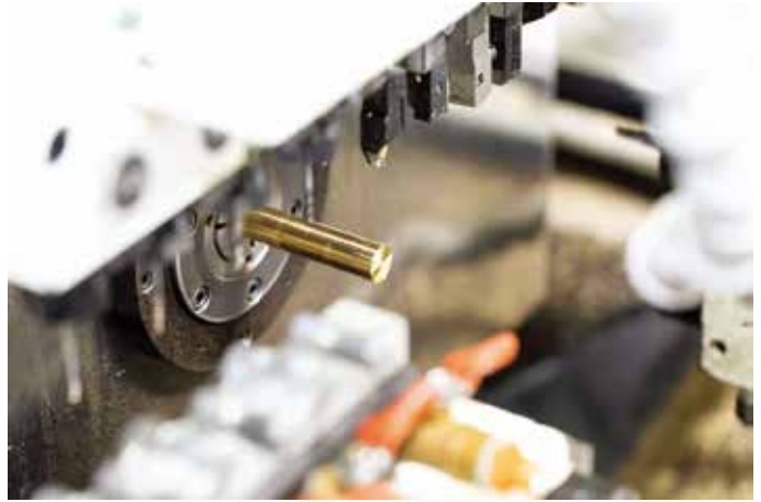
由于黄铜的高速可加工性, SPR 的 7 轴瑞士式机床可以快速地钻深孔, 车间在长时间的轮班中能够保持精度并延长刀具寿命。
