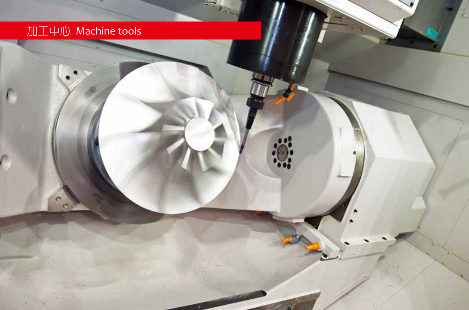
五轴加工中心，例如这款 Okuma MU-5000V-L 五轴 VMC，允许车间在一次操作中加工高度复杂的工件，减少在制品，同时提高零件质量和盈利能力。（图片由 Okuma 美国公司提供）
