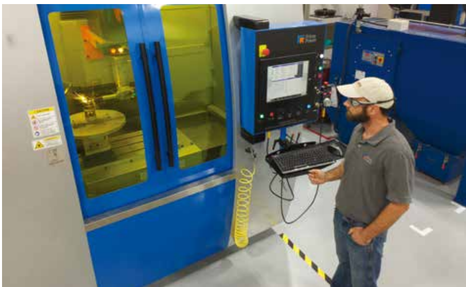
Robert Kissiday 是 Shapes Precision Manufacturing 公司的首席激光技术员，正在观察 Laserdyne 430 系统在航空不锈钢滚针轴承座上的切割槽。
