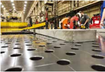
Fairbanks 的团队用 Bluco 的肘杆式夹具进行实验，该夹具可产生高达 400 磅（181.44 公斤）的夹持力。（图片由 Fairbanks Morse 和 Bluco 提供）
