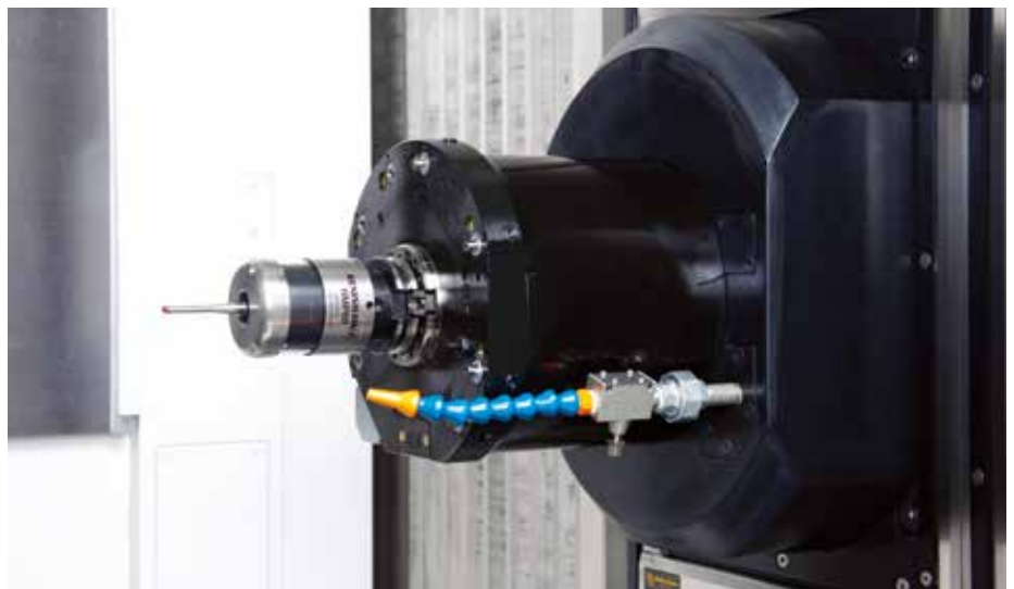
除了检查工件位置和设定偏移量外，主轴测头（例如 Okuma 机床上的 Renishaw RMP60）还可用于识别来自托盘系统的不同工件，减轻了操作员在规划方面的负担。（图片由美国 Okuma 公司提供）
