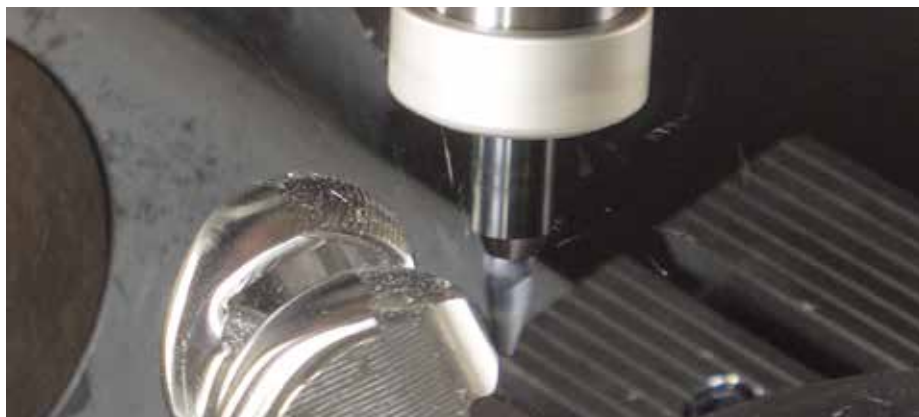
Iscar 的 NEO Barrel 鼓形锥度立铣刀，如图所示，有多种尺寸以及两种不同等级的 Multi-Master 和实体刀具配置。（图片由美国 Iscar 公司提供）
