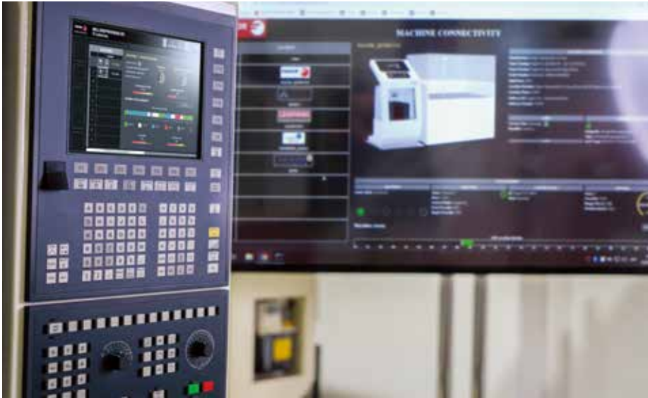
法格的 ARFS（自适应实时进给和速度）控制功能提供了自适应控制能力，可持续监测主轴和运动轴的负载、机器振动和其他数值。（图片由 Fagor Automation 公司提供）
