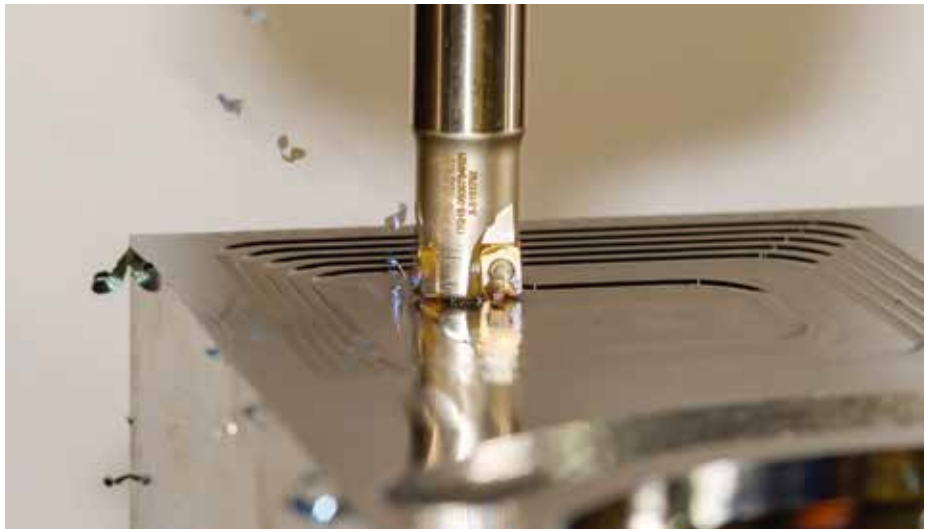
英格索尔为粗加工和精加工提供了小至 4mm 的 IC 刀片，通过更高密度的刀具实现了更高的生产率，降低了刀具成本，并由于减少切削力而提高产品性能。（由英格索尔切削刀具公司提供）
