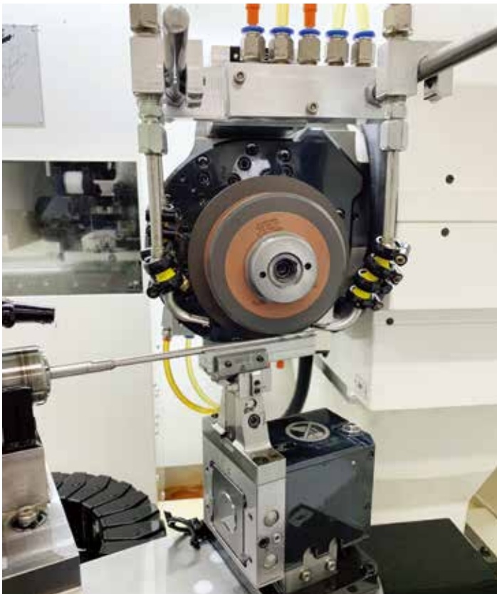
在 Alden Tool 公司使用 Rollomatic GrindSmart 630XS 对医用钻头进行刃磨。（图片由 Alden Tool 公司提供）
