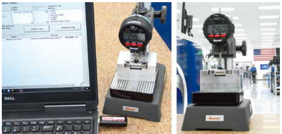
来自固定式数字指示器支架的摇臂轴测量数据被传送到笔记本电脑 (左) 或在工厂对面 200 英尺 (61 米) 处的检查员 (右) 手中。
