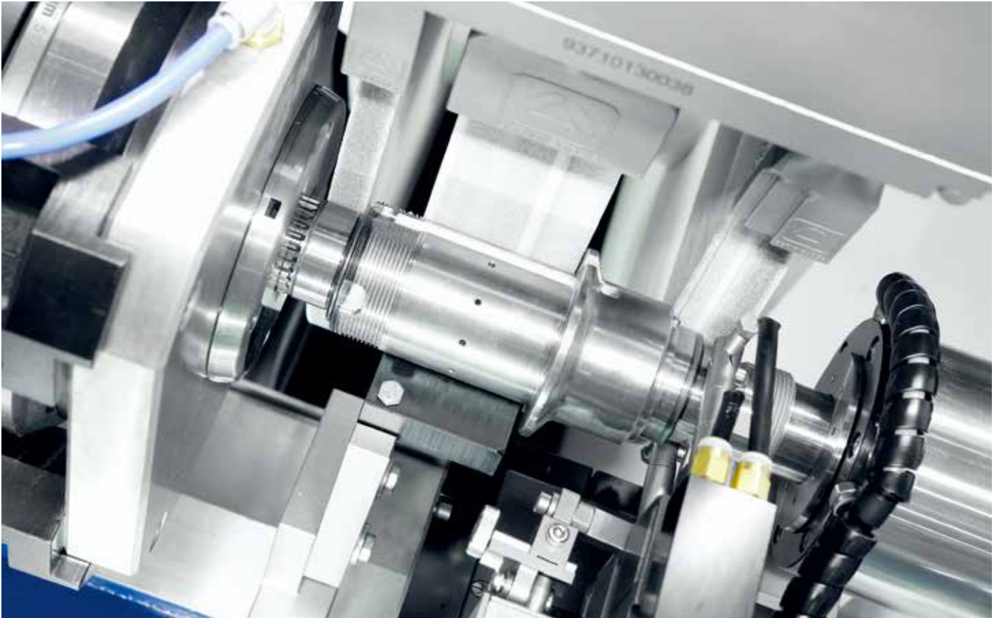
新的 DANOBAT CG 研磨电动马达轴。砂轮速度为 80m/s (16,000 sfpm)，该机器可提高 20% 的生产率。(图片由 Danobat 公司提供)
