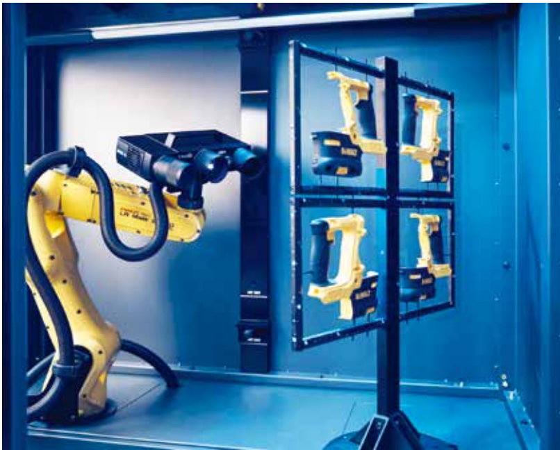
用 ATOS 扫描仪自动扫描塑料部件。(图片由 Capture 3D 提供)
