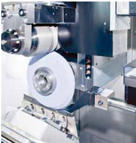
连续修整蠕动进给磨削是一个高度可预测的过程，在难以加工的材料上提供高 MRR。（图片由北美联合磨削公司提供）
