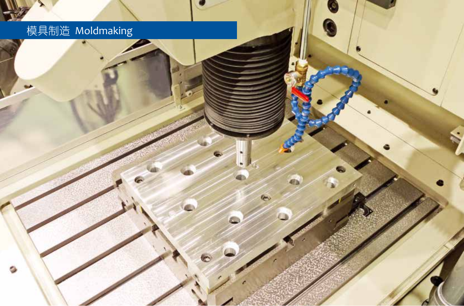
模座制造商使用靠模铣床和靠模磨床来完成精密孔加工，其圆度、垂直度和直线度的公差可小于 5 \mu m。(图片由三井精机提供)
