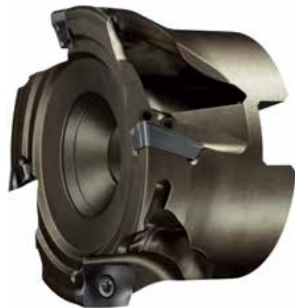
Sandvik Coromant 公司打印了新型 CoroMill 390 的整个钛合金刀具主体，优化了冷却液通道并减轻了重量，这有助于减轻振动，尤其是在长行程应用中。(图片由 Sandvik Coromant 公司提供)
