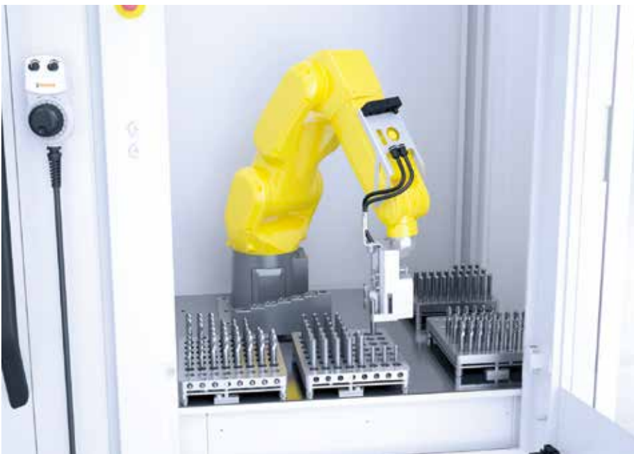
一台配备 HPR 250 机器人的 VGrind 340S 机床，可以在无人看管的情况下管理多达 900 把刀具。(图片由 Vollmer 公司提供)
