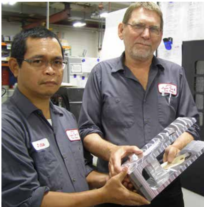
Linda Tool 公司生产经理 Dave Holmes (右) 与公司机械师一起拿着一个正在加工的铝制起落架零件。
