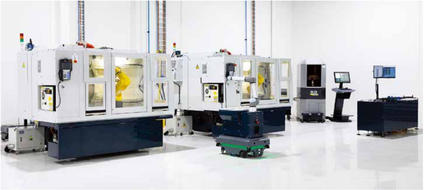
ANCA 的 AIMS 系统连接了一系列刀具制造过程，以管理生产和数据。(图片由 ANCA 公司提供)
