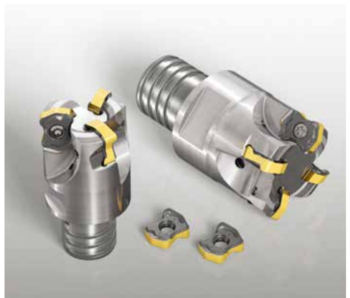
Iscar 公司的 LOGIQ4FEED 系列小直径快速进给铣刀具有狭窄的骨状双面刀片，其有四个切削刃，可以用于粗加工，特别是加工模具等深腔。(图片由美国 Iscar 公司提供)
