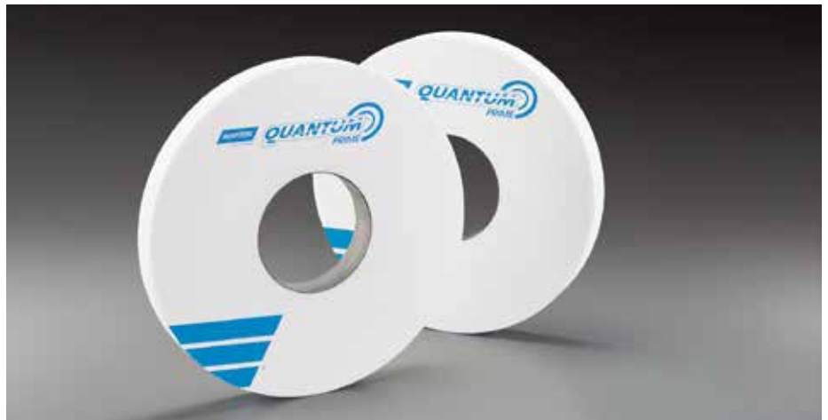
新的 Norton Quantum Prime 是一种易碎的陶瓷颗粒，这比早期的砂轮更容易产生微裂和自锐性，但同样具有很长的寿命，以提供更高的 MRR 和每个砂轮加工加工的零件量。（图片由 Norton | Saint-Gobain Abrasives 公司提供）
