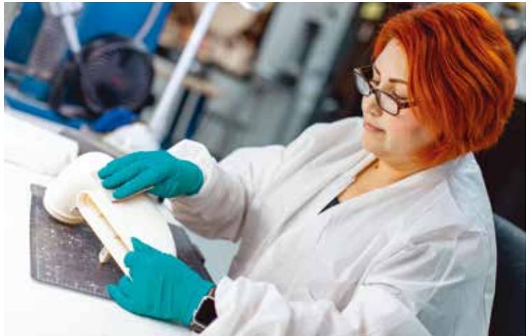
对激光烧结尼龙制成的风管进行最后的处理。(图片由 Stratasys 公司提供)
