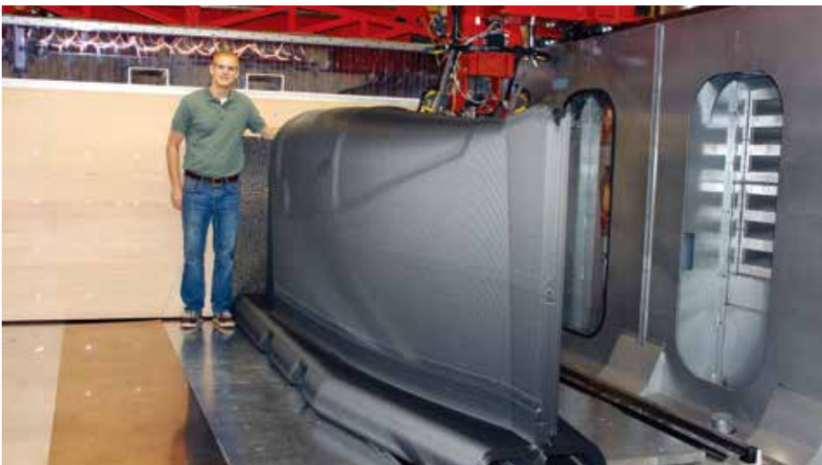
Boeing 公司和 Thermwood 公司采用 AM 技术为 777X 项目生产了一个大型的单件工具。Thermwood 公司使用大型增材制造 (LSAM) 设备和垂直层 (VLP) 3D 打印技术，将该工具制作成一个整体，消除了组装多个 3D 打印工具零件所需的额外成本和时间。(图片由 Thermwood 公司提供)
