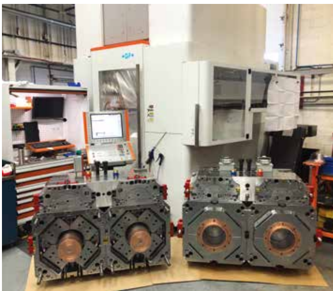
模具制造商 Moulexpert 选择了 Mikron MILL P 800 U ST 机床来实现 5 \mu m 范围内的公差加工，这是对于加工包装行业的薄壁模具至关重要。(图片由 Moulexpert 和 GF 加工方案公司提供)
