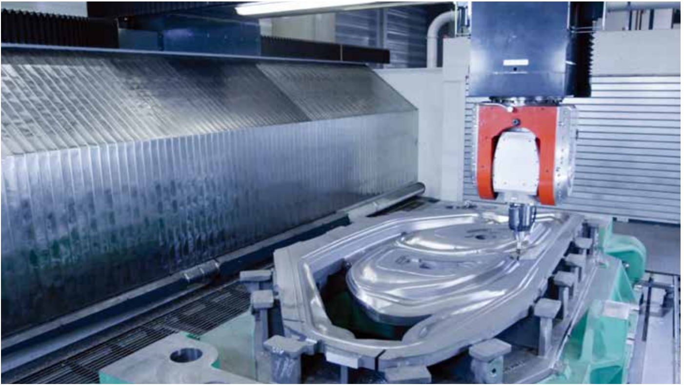
SINUMERIK ONE 数控平台能够在控制上直接调整高速和轮廓公差 的设置 ，而不会激发不利的机械振动，这些振动将不可避免地显示在工件的抛光表面上。(图片由西门子公司提供)
