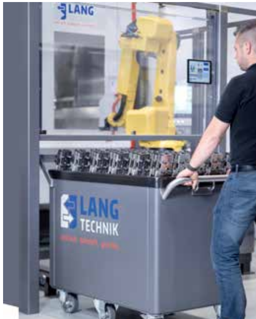
Lang Technovation 公司的 RoboTrex 自动化系统控制一个 FANUC 机器人和最多四个可移动小车，每个小车包含多个预加载的虎钳。(图片由 Lang Technovation 提供)
