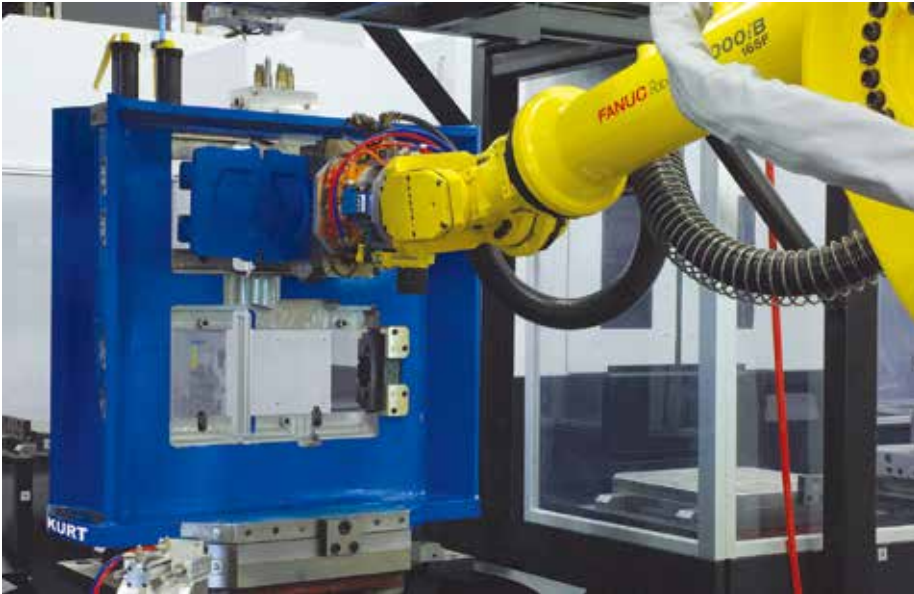
一个自动化窗口夹具极大地提高了自动化FMS生产线的产量。 (图片 Kurt Manufacturing 公司工业产品部提供)
