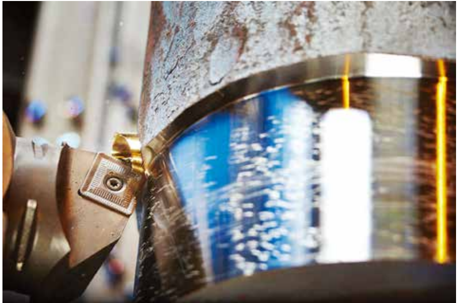
图中为使用带有CVD涂层的硬质合金刀具加工专用的高强度钢船轴。（图片由Seco刀具提供）
