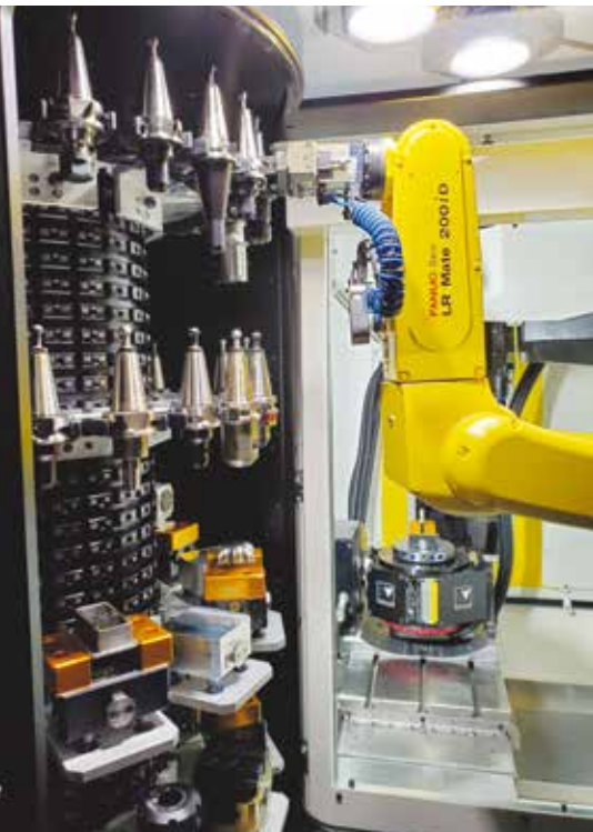
因为它可以更换刀架以及预装托盘，所以 RoboDrill Plus-K 甚至适用于非常小批量的作业。（图片由 Methods Machine Tools 提供）
