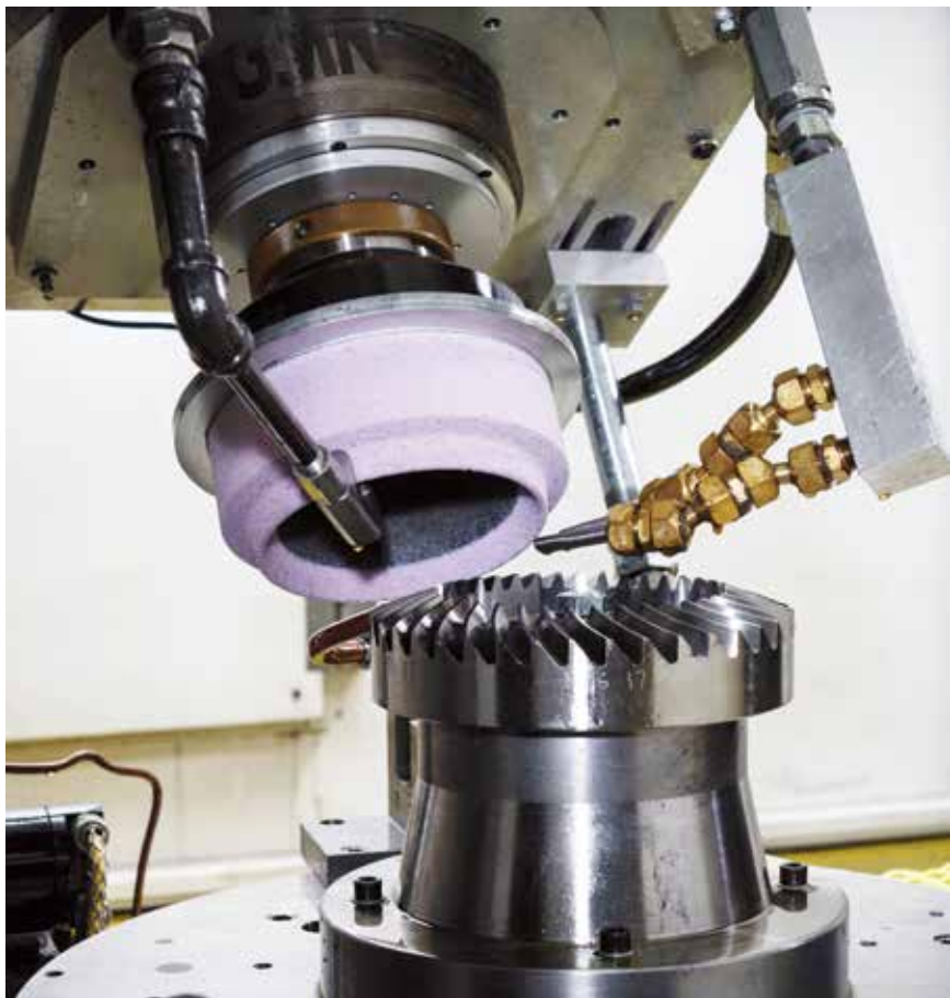
Norton 公司的 Xtrimium 砂轮已经经过了现场验证, 表明了可以有有效的完成实心材料的锥齿轮磨削。(图片由 Norton | Saint-Gobain Abrasives 提供)
