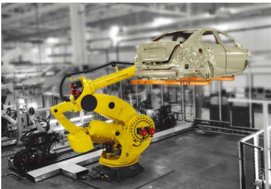
超重负载机器人（M-2000iA 系列）具有全腕关节的功能，用于搬运极重的物品，如卡车、拖拉机和汽车车架、装载的托盘和大型铸件（高达 2,300 公斤）。（图片由 FANUC 提供）
