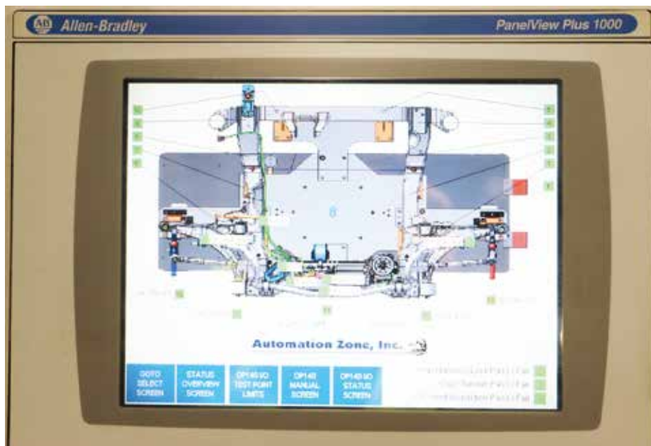
当 UR10 进行检查时，发动机的图表会实时显示每个执行的检查结果，用绿色或红色的检查标记表示通过或失败。
