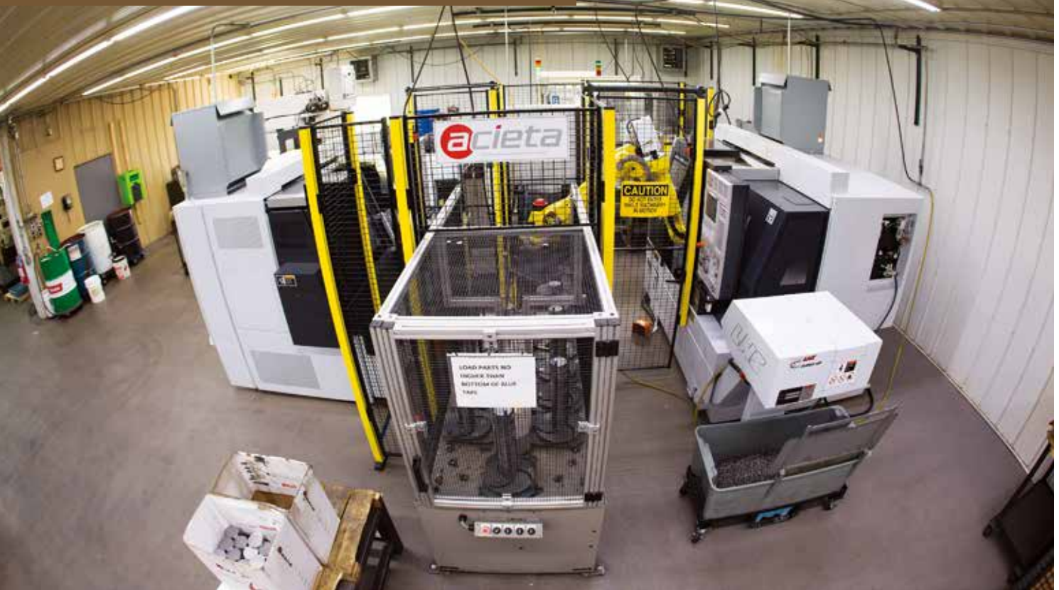
Acieta 客户 Central United 使用一台 FANUC M-20iB 机器人来操纵两台车床。一位操作员将原始零件装载到传送带或排队站，以供机器人抓取。（图片由 Acieta 提供）
