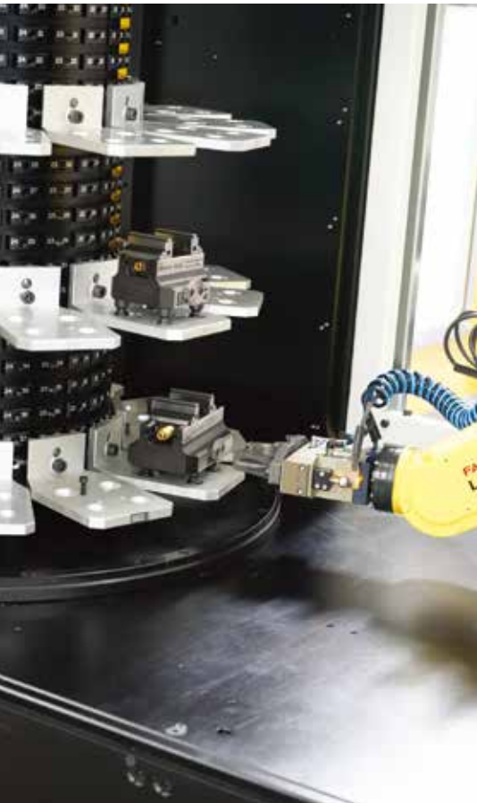
Methods PlusK 系统和类似的转盘系统使用一个通用托盘来装载各种零件，简化了机器人编程和机床安装。(图片由 Methods Machine Tools 提供)
