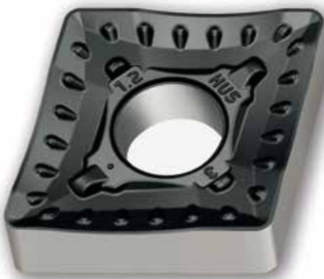
由于具有弯切削刃和深排屑槽，HU5刀片即使在高速进给率下也将产生较低的切削力。（图片由Walter公司提供）
