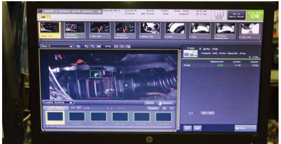
配备摄像头的 UR10 拍摄的每张图像都会被立即处理，检查结果会显示在机器人旁边的屏幕上。
