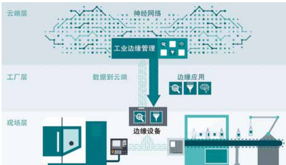
边缘计算就是将大部分计算和处理保留在边缘设备上，而不是 CNC 上，这保证了机器可以在同一时段实时运行。从而扩展了数控系统的能力，提升了不同数控系统间的可替代性。（图片由 Siemens 提供）
