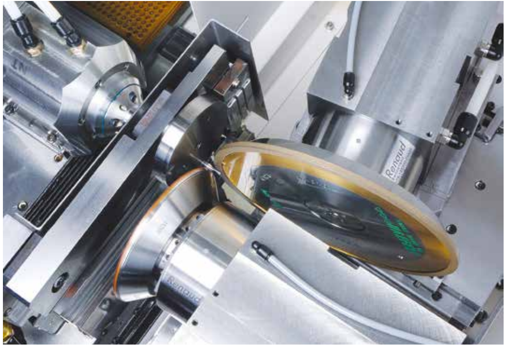
Rollomatic 的 NP5 磨床通过环境温度控制，可将零件尺寸公差控制在 0.4\mu\text{m} 以内。（图片由 Rollomatic 提供）
