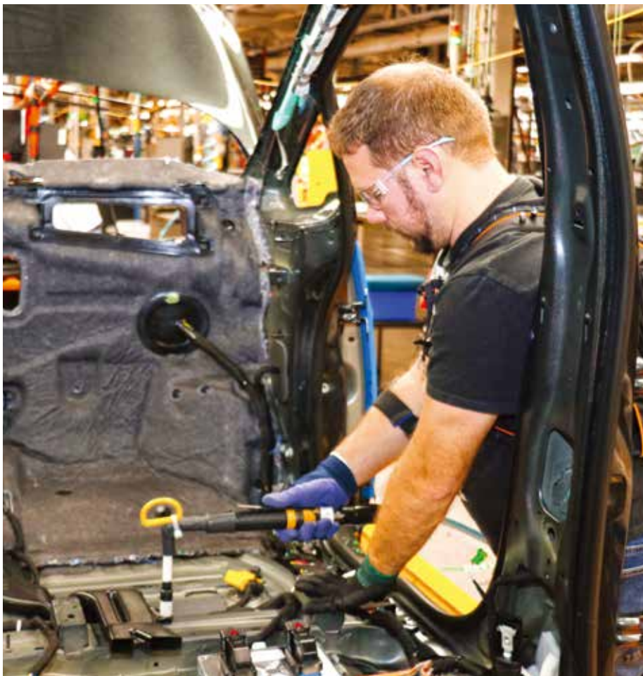
通用汽车公司的 Ironhand 在铆钉枪操作的重复性动作中提供帮助，其也可以协助持续保持动作，例如在组装汽车时抓紧一捆电线。
