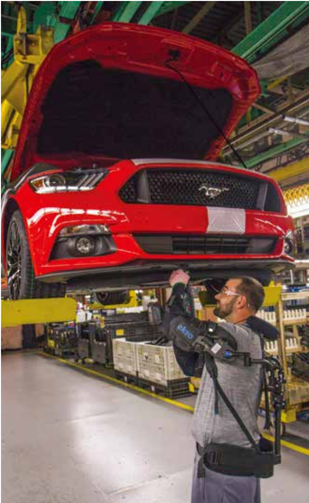
福特汽车公司的EksoVest是一种负重外骨骼机器人， 可以减轻高空作业操作员的肩部肌肉压力。
