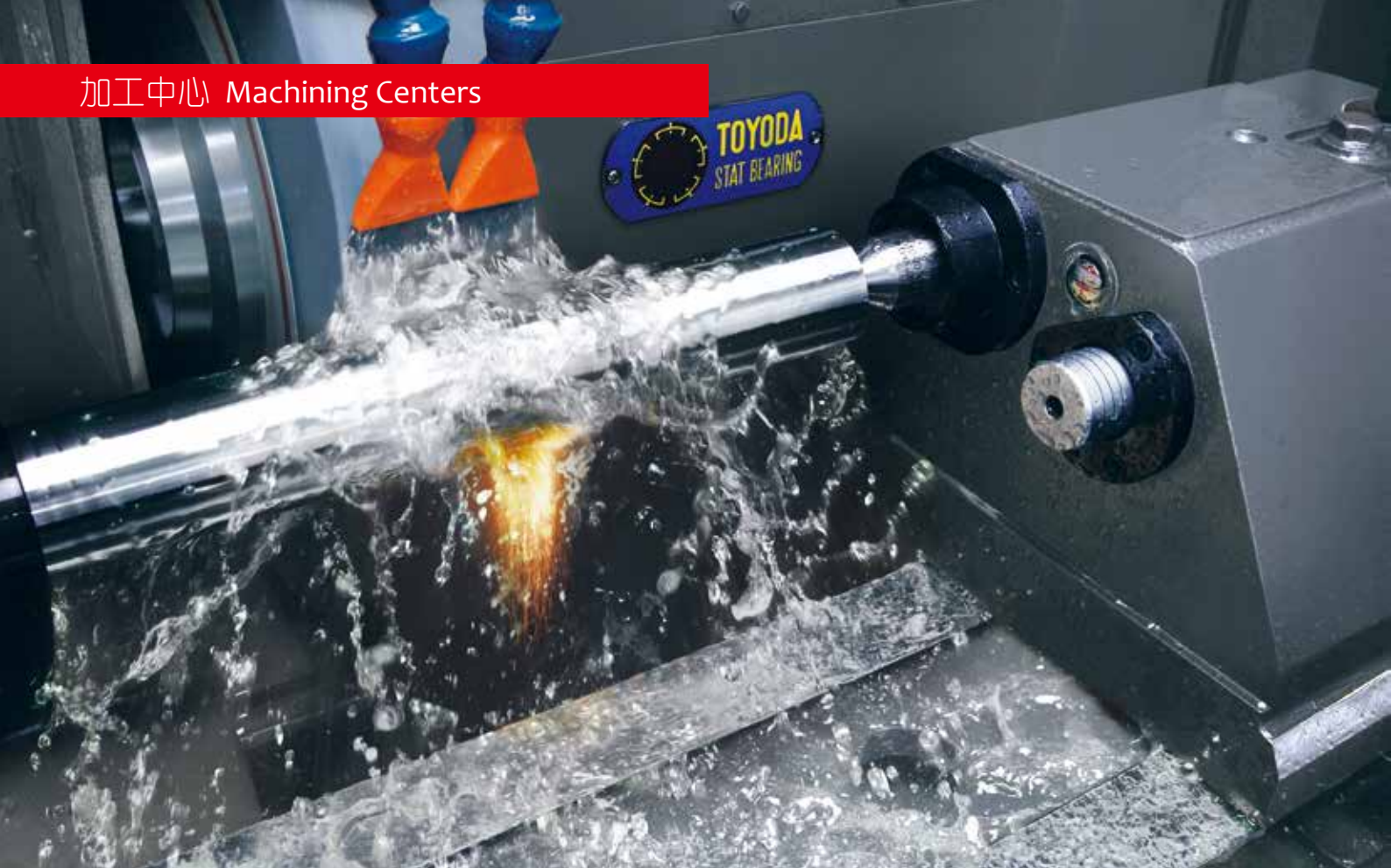
图中 Toyota 的外圆磨床展示了冷却剂的重要性。（图片由 JTEKT Toyota Americas 提供）
