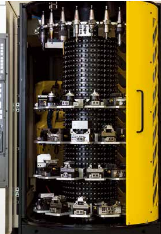
Methods PlusK 系统可将零件和切削刀具以任何组合方式加载到 FANUC RoboDrill 中，使机器能够在没有干预的情况下进行一系列的“一次性”加工。（图片由 Methods 提供）
