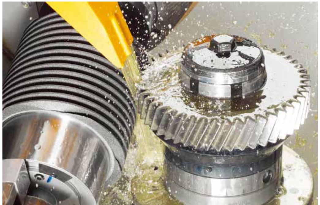
CBN 刀具展成研磨是一种经济性、可替代刚玉研磨的加工方法。 (所有图片均由 Liebherr 提供)
