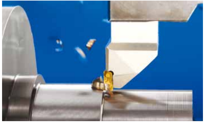
Heliturn 刀具具有螺旋形的切削刃。 (图片由 Iscar Metals Inc. 提供)
