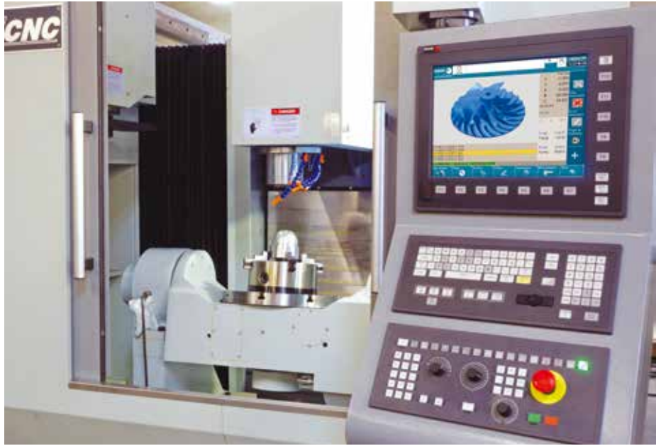
Fagor 的控制装置在同一台 CNC 上同时采用了 G 代码和对话式编程系统，除此外还有板载的 CAD/CAM 系统、交互式编辑器和帮助模式。（图片由 Fagor Automation 提供）
