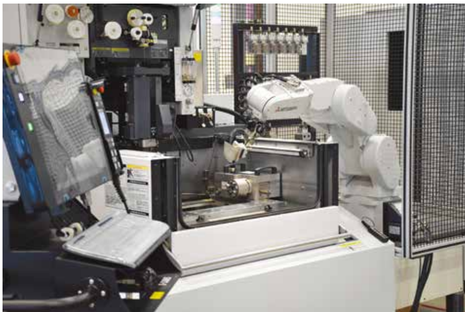
电火花线切割加工设备上的六轴机器人提供了定位的灵活性，可以在旋转台设置的任何角度装载零件，以获得最佳的加工间隙。（图片由 MC 机械系统公司提供）
