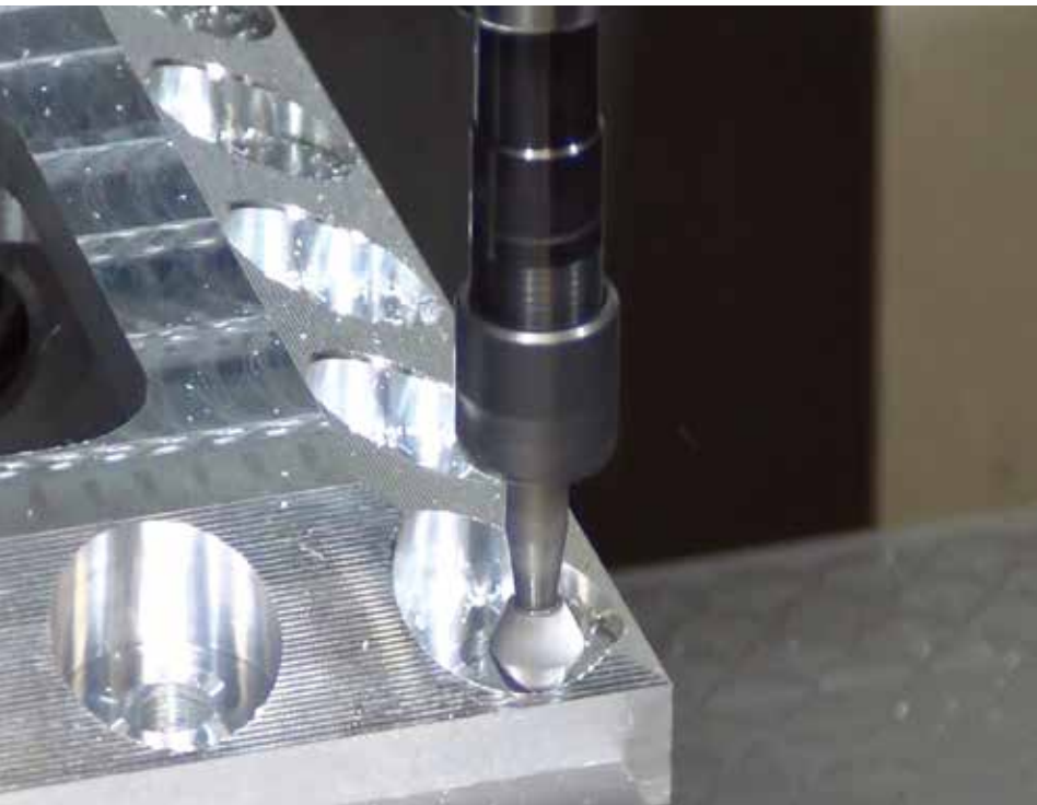
DeBurr-Z 凭借其内部张力 - 压缩机构，即使在表面高度不同的情况下，也可以去除工件两侧和内孔交叉处的毛刺。（图片由 Tapmatic 提供）
