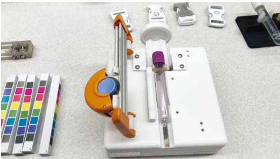
并非所有由 3D 打印机制造的设备都用于患者。Mayo 公司为一项研究征集了数千份标本样本, 需要从试管上取下标签, 事实证明, 这对工作人员来说是很繁琐的, 甚至会造成伤害。工程部利用其工程级塑料 3D 打印机创造了一个独特的标签去除器。
