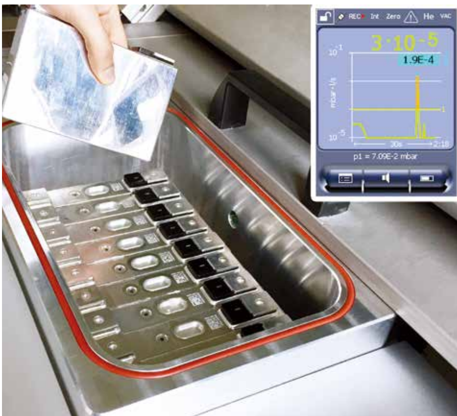
棱柱形电池被放置在一个腔室中进行泄漏测试。
