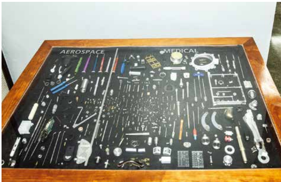
Precision Swiss Products 公司生产的医疗和航空航天零件的加工公差可达到 \pm 0.00015" (0.0038mm)，其几何形状错综复杂，可能需要用极小的刀具进行多达六次的加工操作。
