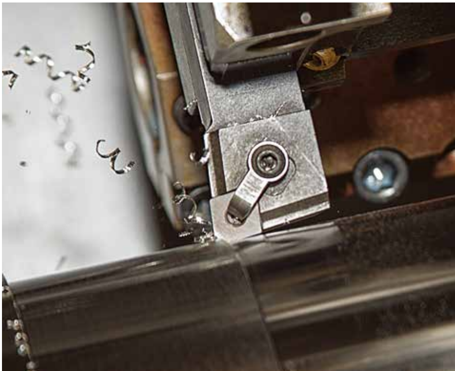
Greenleaf 公司的 XSYTIN-1 晶须强化陶瓷刀片可以在同一次切割中同时处理镍基合金和不锈钢。(图片由 Greenleaf 提供)
