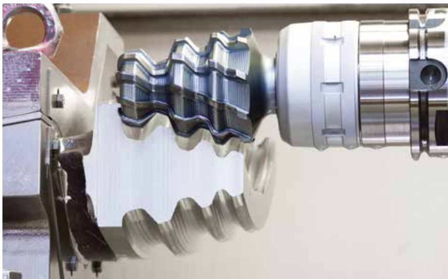
针对涡轮叶片根部形状，Emuge 公司的新款 Pagode 铣刀比传统枞树型铣刀具有更多的切割刃。该公司表示，其效率能提高 2-10 倍。（图片由 Emuge 提供）
