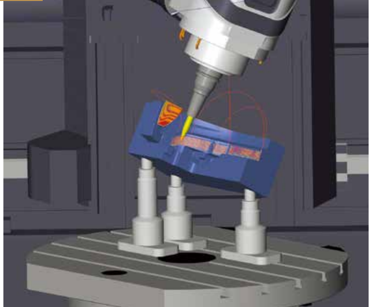
Open Mind Technologies 的 hyperMILL CAD/CAM 软件包括一个虚拟加工优化器，可分析整个加工序列并同时考虑轴加工中各轴的限制。
