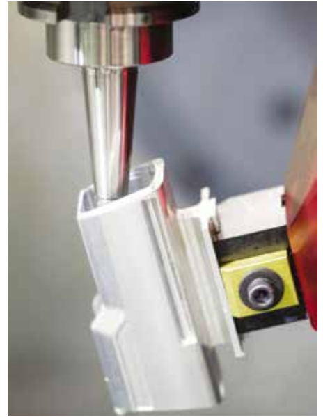
Trek Bicycle 公司使用 MEGA 微型卡盘进行加工的特写。BIG Kaiser 公司称，这种卡盘在伸长的情况下具有极高的刚性。
