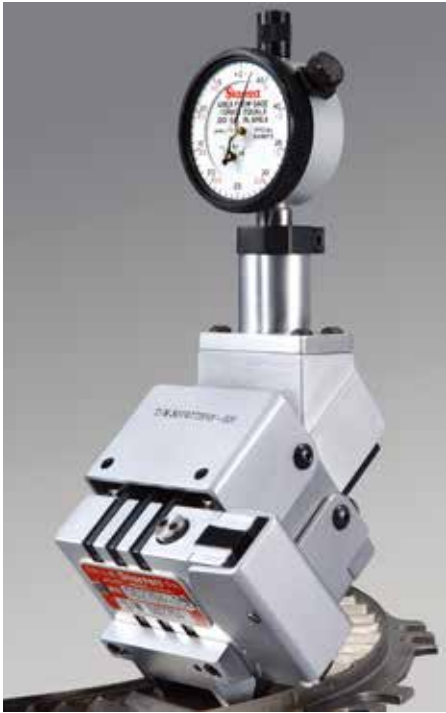
Starrett 的流量计可用于测量涡轮发动机喷嘴的面积开口，并以 0.001 in 2 (0.645 mm 2 ) 的分辨率显示结果。 (图片由 U L.S. Starrett 提供)
