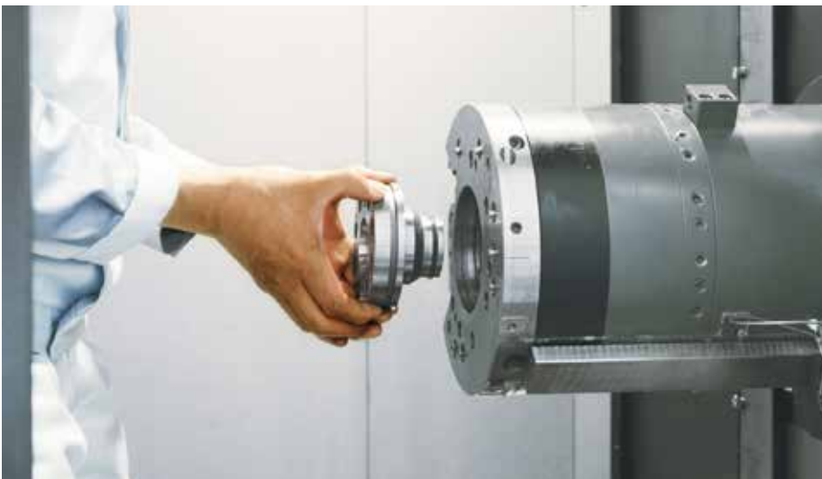
JTEKT Toyota 公司的可更换主轴帽在大多数情况下都能实现快速、相对低成本的维修，而且其重复率在 2μm 以内。（图片由 JTEKT Toyota Americas 公司提供）
