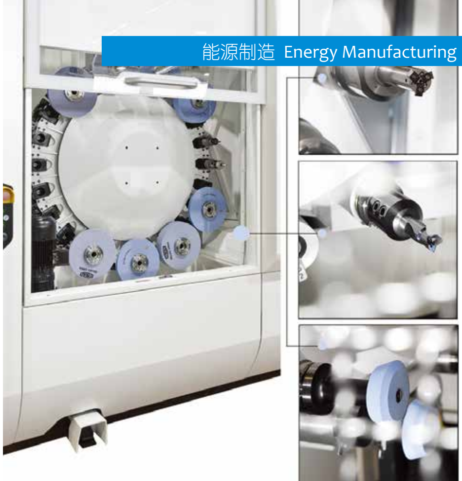
Mägerle MFP 磨床具有自动换刀功能。RFID 芯片能够确保正确的刀具载入主轴。(图片由北美 United Grinding 提供)
