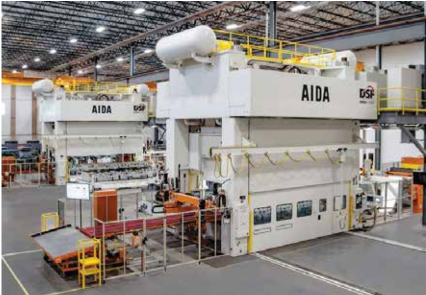
两台 AIDA DSF-S4-20000 2,000 吨伺服传送压力机，全行程长度 750 mm，可编程至 200 mm，最大速度 40 冲程 / 分钟，可编程至 1 冲程 / 分钟。( 图片由 AIDA-America 公司提供 )
