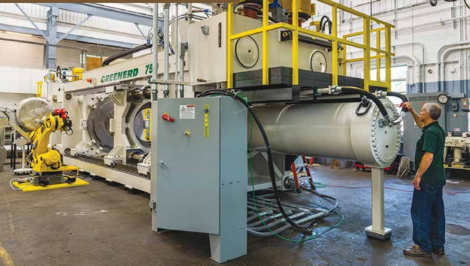
Greenerd 公司设计并制造了这台定制的复杂双移动压板深冲液压机。它完全集成了两台六轴 FANUC 机器人（用于装载 / 卸载），并促使压力机能够执行生产重型高压缸罐所需的多种操作。（图片由 Greenerd Press & Machine 公司提供）
