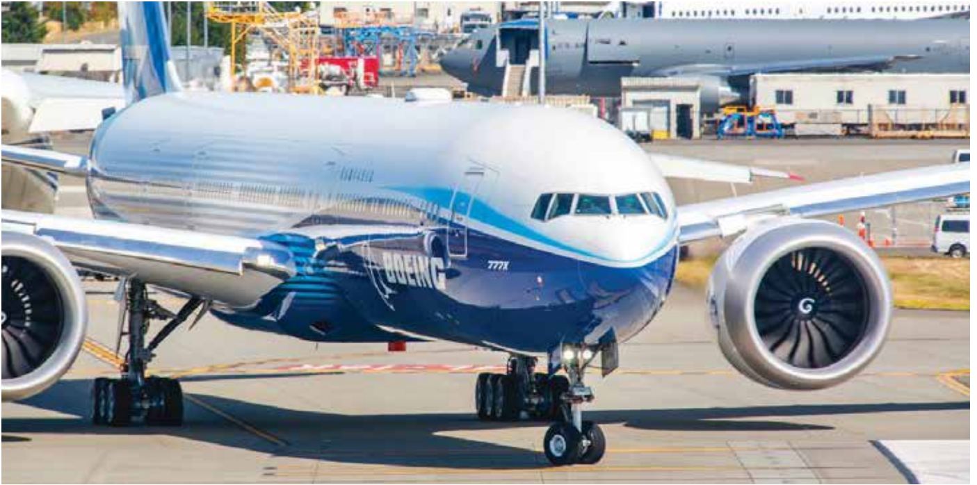
一架波音 777x 在西雅图 Everett 机场进行高速滑行测试。777X 将采用新的 GE9X 发动机。
