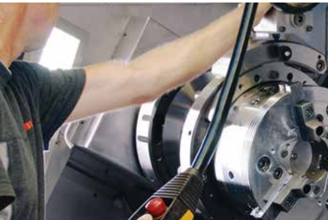
安装辅助装置可将工件夹持装置的更换时间缩短至五分钟之内。
