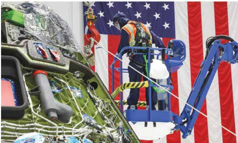
一名波音 CST-100 技术人员在吊装过程中密切关注飞船乘员舱。打开的端口用特殊的低粘性胶带覆盖，以防止被异物损坏。
