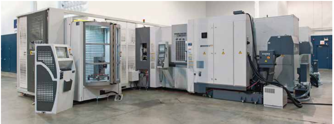
如图所示，配备适当刀具和程序的柔性制造系统 (FMS) 即使在多品种、小批量加工中也能轻松超越传统加工中心。(图片由 Okuma America 提供)
