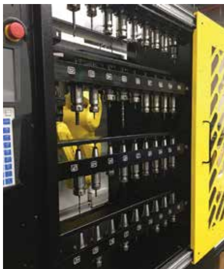
充足的刀库和所谓的“酒架”对于减少多品种、小批量加工环境中的设置时间至关重要。（图片由 Methods Machine Tools 提供）
