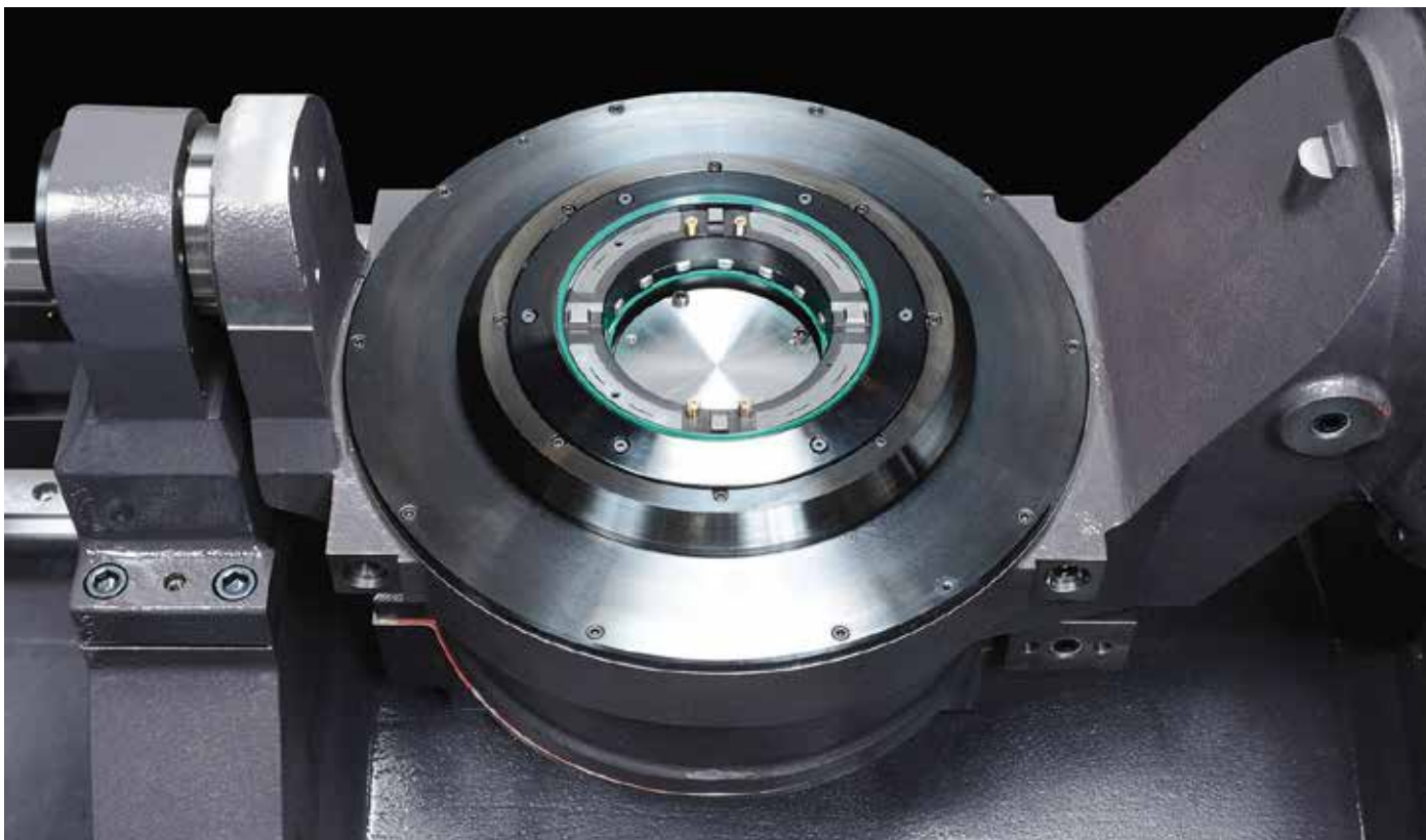
这台来自 Methods Machine Tools 的 YASDA PX30i 五轴加工中心配备了快换工件夹具，该夹具是托盘交换系统的一部分。（图片由 Methods Machine Tools 提供）
