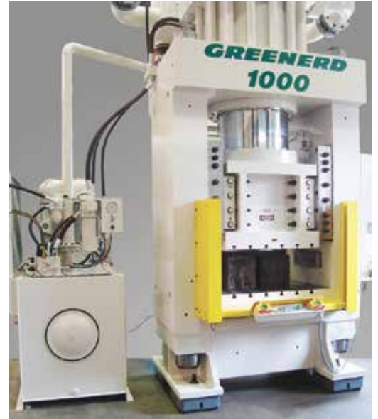
这台 Greenerd 1,000 吨液压机用于锻件的冲压作业。这台 1,000 吨压力机的规格为每平方英尺 110 吨，床身尺寸为 30" × 30"。压力机采用摇臂导向，可处理偏心装载，还提供安全光幕套件。( 图片由 Greenerd Press & Machine 公司提供 )
