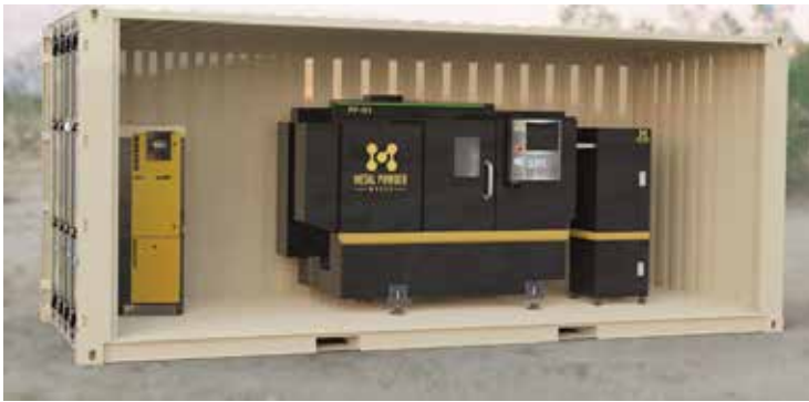
Metal Powder Works 的机械生产工艺不依赖气体雾化来生产金属原料，因此能耗更低，也不产生工业气体。（图片由 Metal Powder Works 提供）
