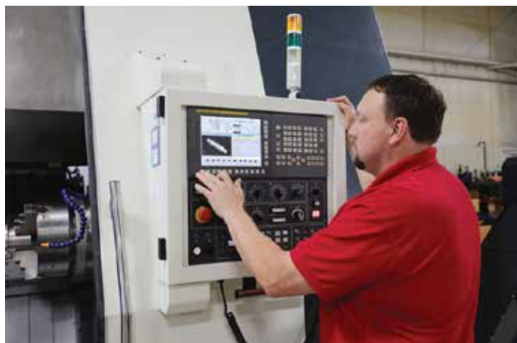
Absolute Machine Tools 应用工程师 Jason Lutch 在该公司的一台 Johnford ST-60 斜床身数控车床上准备一项工作。他说，优化车间的刀具库和操作参数对于“最大化工作效率”至关重要。（图片由 Methods Machine Tools 提供）
