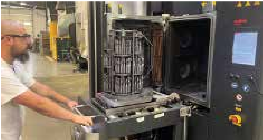
在 Better Edge 装载 Oerlikon Balzers PVD 涂层容器。（图片由 Better Edge 提供）
