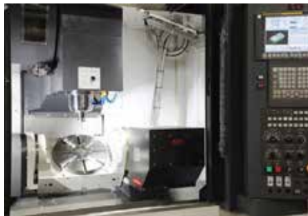
与所有五轴加工中心一样，Absolute Machine Tools 的这台 Tongtai CT-350 能够在一次操作中生产多种复杂零件，从而降低 WIP、设置时间和运营成本。(图片由 Methods Machine Tools 提供)
