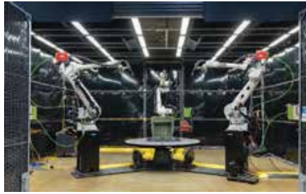
这个增材制造系统结合了三个机器人，共计 18 个数控轴，再加上一个旋转台，总共可同时控制 19 个定位轴。（图片由橡树岭国家实验室提供）
