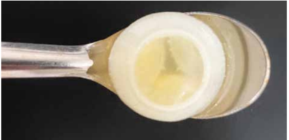
生物打印的胶原心脏瓣膜（图片由 Allevi by 3D Systems 提供）
