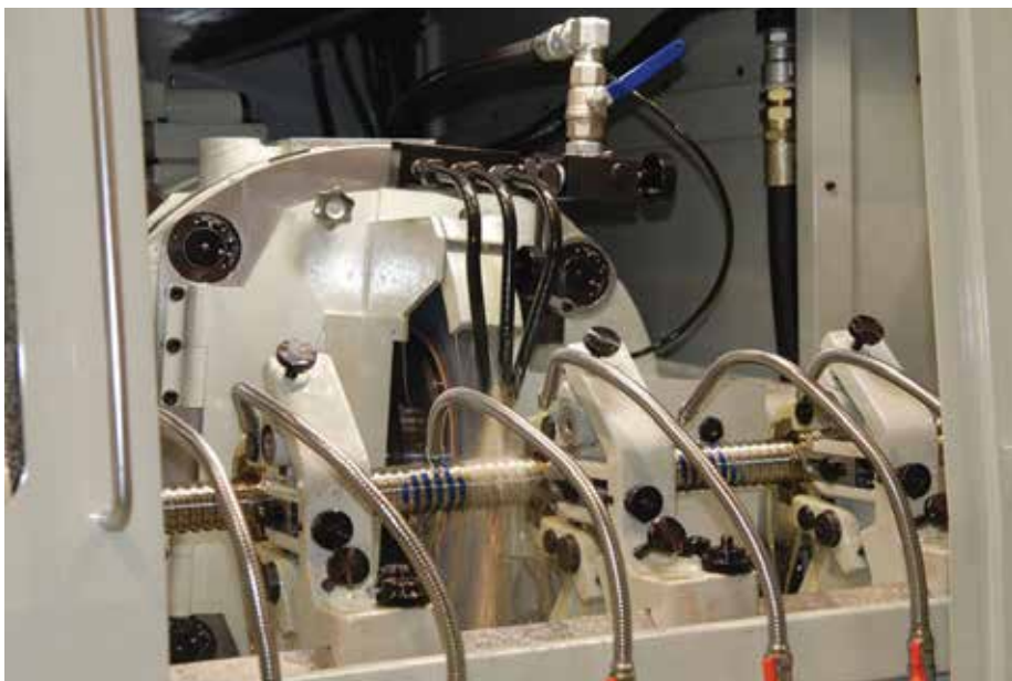
三井精机公司制造自己的精密螺纹磨床，并生产自己的卧式加工中心滚珠丝杠，帮助确保这些关键部件的使用寿命。（图片由三井精机美国公司提供）
