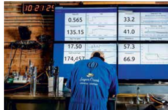
在北卡罗来纳州的 Sugar Creek 啤酒厂，Bosch Rexroth 的物联网网关来自传感器和 PLC 的数据转换并转发到 IBM Watson 云端，以创建仪表盘上显示的信息。
