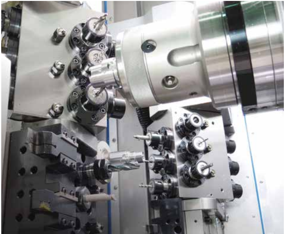
这台来自 Absolute Machine Tools 的 QuickTECH i42/i60 Ultimate 车削中心，具有 10 个轴，包括两个车削主轴、两个铣削主轴（具有同时加工功能）和两个 B 轴。它共有多达 39 个刀具，其中的 24 个为带有 B 轴铣削功能的活动刀具。（图片由 Absolute Machine Tools 提供）
