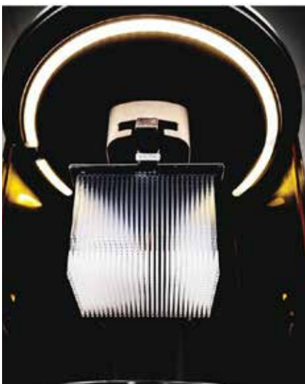
这些鼻咽拭子是用 Carbon 公司的数字光合成 (DLS) 技术开发的, 通过使用柔软的柔性材料, 使病人感到舒适。(图片由 Carbon 公司提供)
