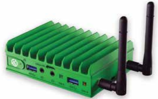
利用 MachineMetrics 公司为加工机器提供的即插即用工业物联网平台，制造商可以从任何机器中收集数据。边缘性软件可以实时处理来自机器的数据，并将数据流入 MachineMetrics 公司的云端。（图片由 MachineMetrics 公司提供）
