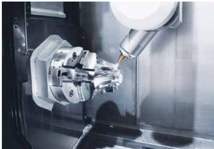
Mazak INTEGREX I-200S AM 将完全五轴加工与安装在五轴龙门上的独立 AM 头相结合。在减材加工过程中，AM 头会移动到远离加工屑或冷却液的存储区域。（图片由 Mazak 提供）
