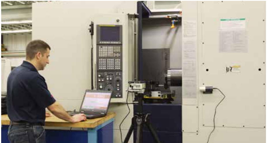
为了说明预防性维护的重要性，Methods 公司的一名技术支持人员对 KIWA KH-4500kai 进行了诊断测试。（图片由 Methods Machine Tools 公司提供）
