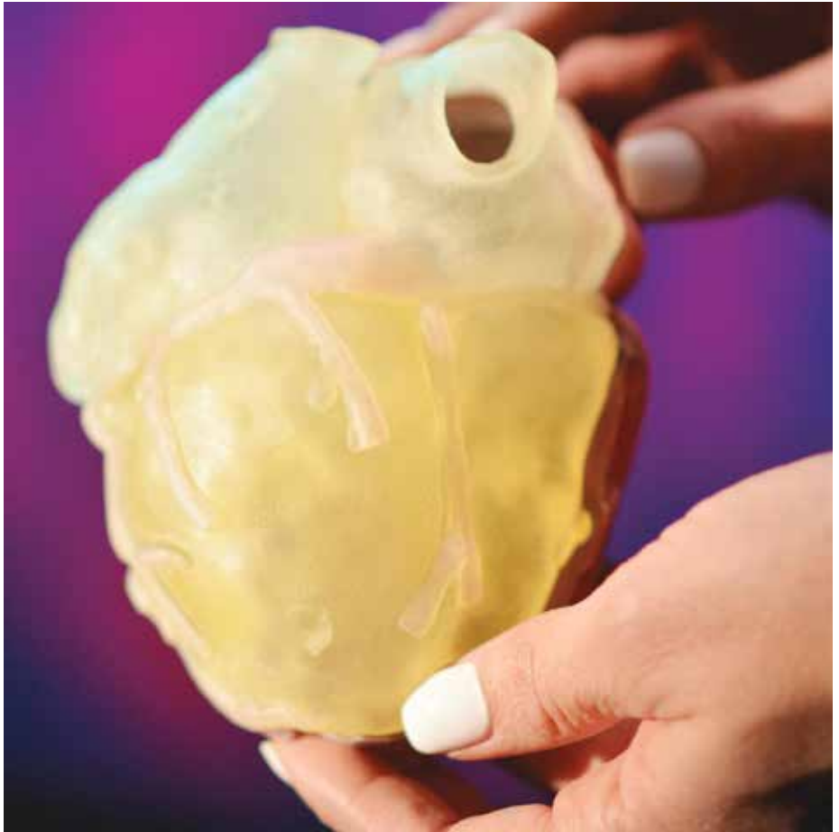
使用 Stratasys J750 Digital Anatomy 3D 打印机创建的的心脏模型。（图片由 Stratasys 公司提供）。
