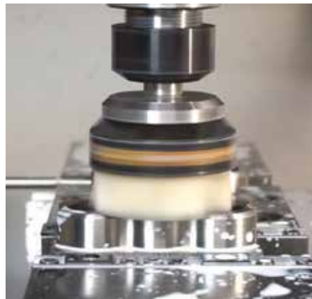
另一个用于轻度去毛刺、破边和表面精加工的选择是磨料尼龙刷。在某些情况下，这种类型的工具还可以消除传统上由倒角工具和面铣刀进行的加工操作。
