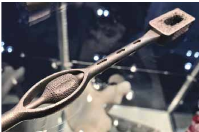
这台脊柱保持器是与 3D Systems 公司合作, 用 17-4 不锈钢快速设计和 3D 打印的。(图片由 3D Systems 公司提供)。
