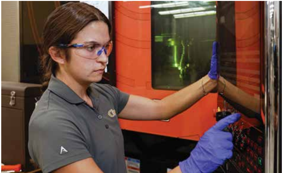
研究员 Lauren Heinrich 操作 Mazak VC-500AM，来进行混合制造和相关的 CAD/CAM。（图片由佐治亚理工学院研究部提供）
