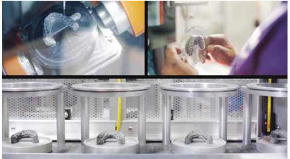
总部位于田纳西州 Nashville 的 SmileDirectClub 已经部署了几十套惠普 Jet Fusion 3D 打印系统，可以每天生产超过 50,000 个独特的口腔模具。(图片由惠普公司提供)
