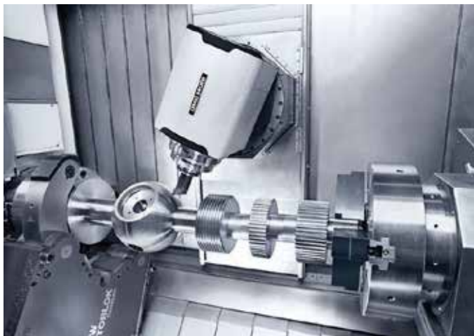
这台 DMG Mori 的 CTX Gamma 3000 TC 车铣复合机床也能实现六面全加工。（图片由 DMG Mori 提供）
