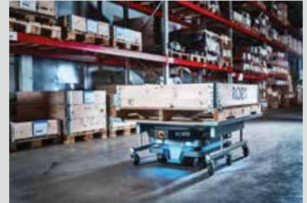
ROEQ 最新推出的推车顶部产品是 TMS-C500 Ext 和 S-Cart500Ext，这两款车协同设计，可使 MiR 250 AMR 的有效载荷增加一倍，并可在不影响安全的情况下运输长度达 1.2 米 (47.2 英寸) 的货物。(图片由 ROEQ 公司提供)
