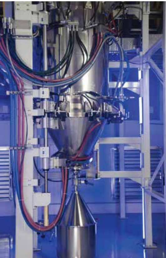
6K Additive 的 UniMelt 微波等离子体系统。(所有图片均由 6K 提供)
