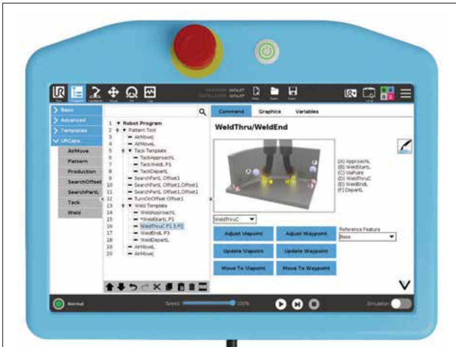
MT Solar 的 UR10e 协作机器人上的教学吊坠使用简单，即使是没有经验的操作员也可以轻松地设置新任务。(图片由 MT Solar 提供)
