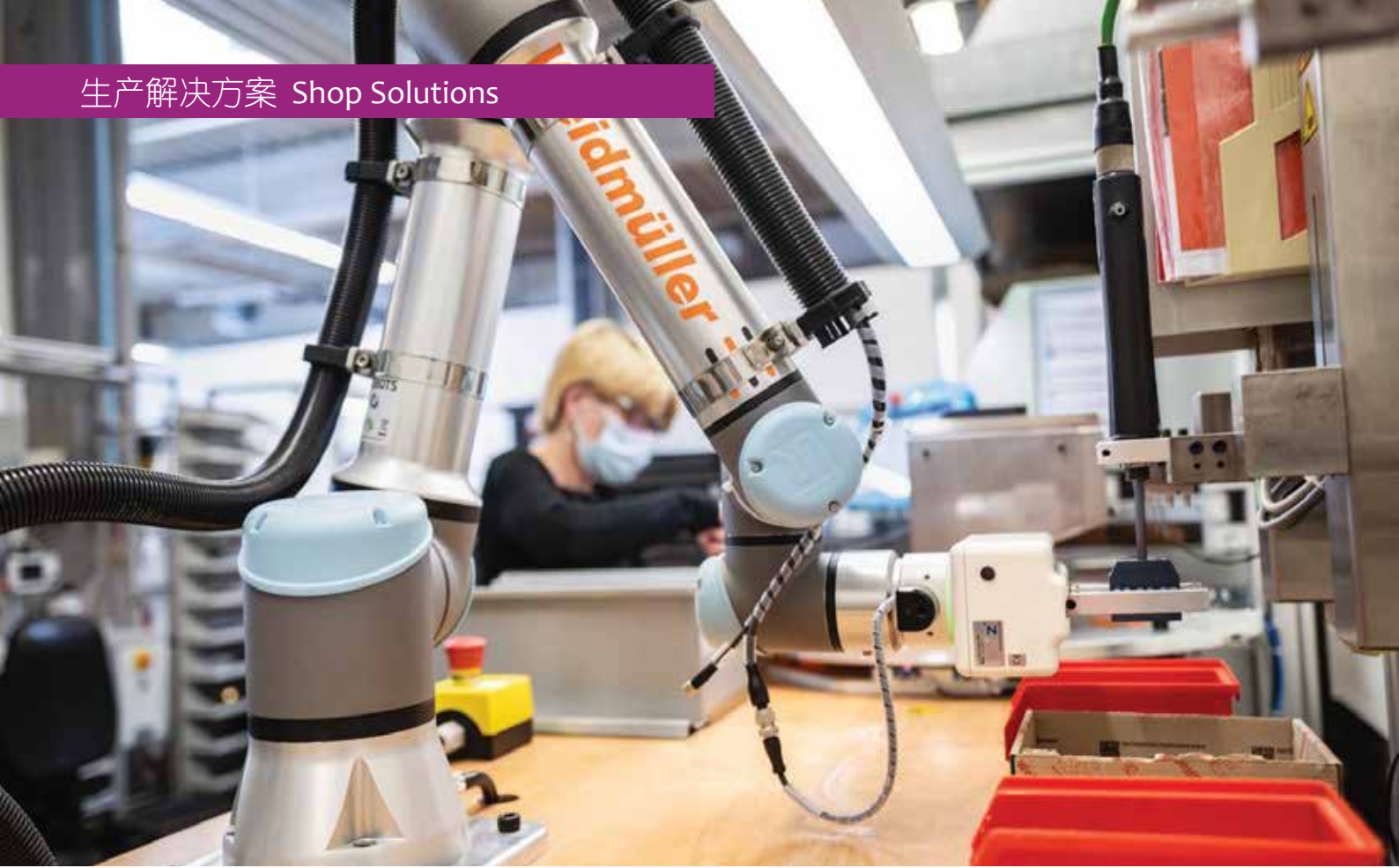
Zimmer 集团的一台带有 HRC 夹持器的协作机器人，在 Weidmüller 的工作场所提供支持。
