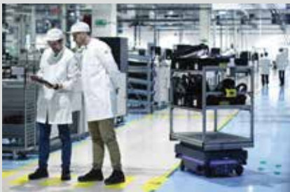
Mobile Industrial Robots 公司建立了一个开源的 AMR 平台，允许第三方供应商生产像这些货架这样的模块顶部配件。(图片由 MiR 公司提供)
