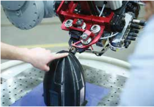
Sinumerik 数控系统不仅能实现七轴插补运动，还可通过添加挤出机控制来实现八轴操作。
