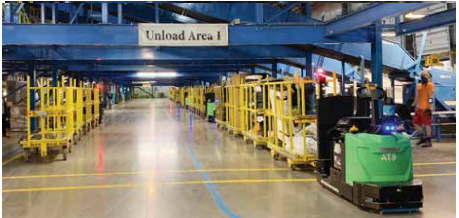
VecnaRobotics 公司的 Oxen 系列牵引车，是为长途运输和重载而设计的，可以自主地抬起装载的小车。（图片由 Vecna 公司提供）
