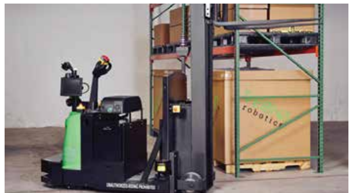
Vecna Robotics 公司的叉车机器人提供高达 72 英寸（1.8 米）的垂直升降，以帮助分销、仓储和制造组织移动更广泛的有效载荷和托盘类型，将库存提升到设备上，并与其他材料处理车辆和人类工人一起安全工作。（图片由 Vecna 公司提供）
