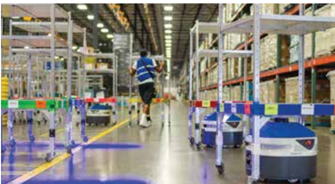
经过编程，用于制造业的 Fetch AMR 可以自行行动，将材料送到仓库并放在架子上，将部件运到生产线上，成为该生产线的一个虚拟部分，甚至可以清除垃圾。（图片由 Fetch 公司提供）
