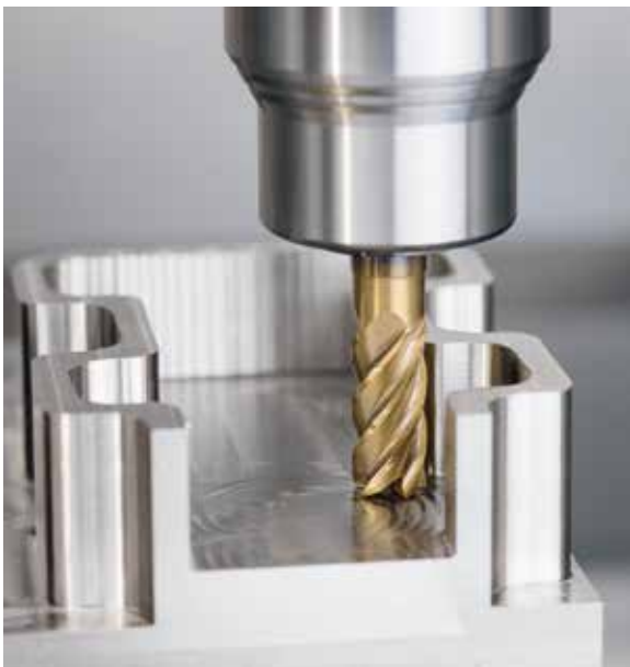
EMUGE-FRANKEN TiNox Trochoidal 立铣刀通过重叠圆形路径运动进行 trochoidal 铣削。与标准设计相比，粗加工和精加工速度提高了 30%。（图片由美国 Emuge-Franken 公司提供）
