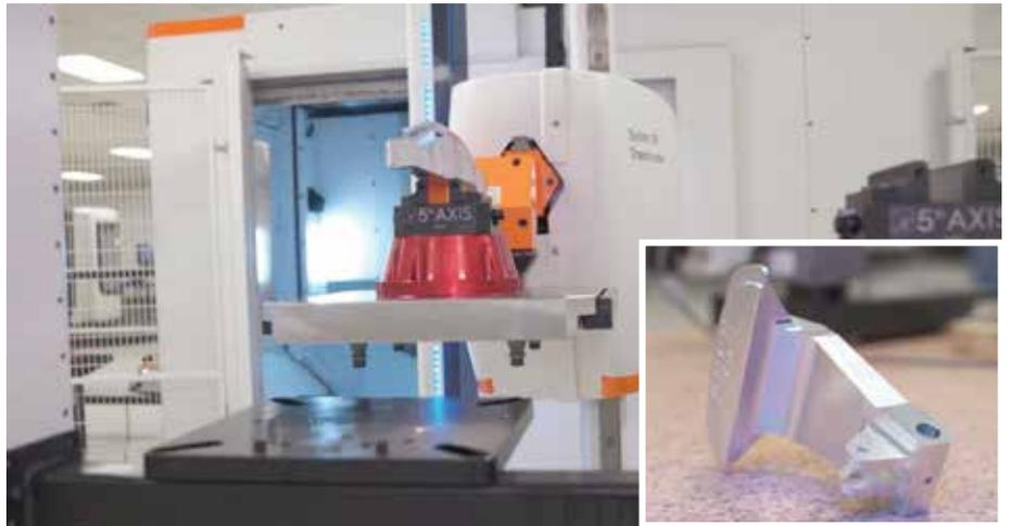
**来自 GF 加工方案公司的 System 3R Transformer 模块化机器人设置在轨道上，在两个 MILL E 700 U 加工中心间切换托盘，并在装载站离线装载和卸载托盘，从而为 Gray 加工技术公司公司提供长时间的熄灯式加工操作。该公司的航空和卫星零件组合较多，单个零件数量较少，车间依靠 GF 加工方案公司的自动化单元进行加工。（所有图片由 GF 加工方案公司提供）**
