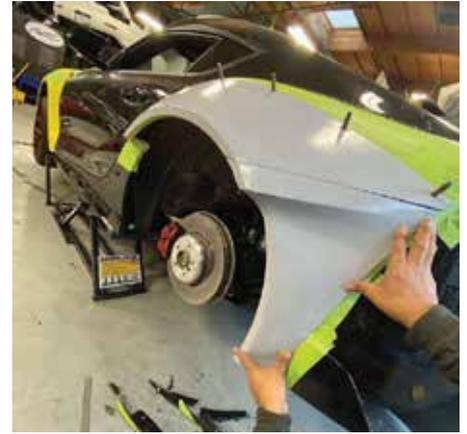
**Massivit 3D 公司与汽车零部件和宽体套件制造商 Streetfighter LA 公司合作开发了 2020 年的 Toyota Supra MK5 宽体套件，包括在 1800 Pro 上 3D 打印的 16 个部件。现在人们可以通过大型 3D 打印机将前唇和后扰流板等大型零部件一次打印成形，其长度最长可达 5 英尺（1.5 米）。**
