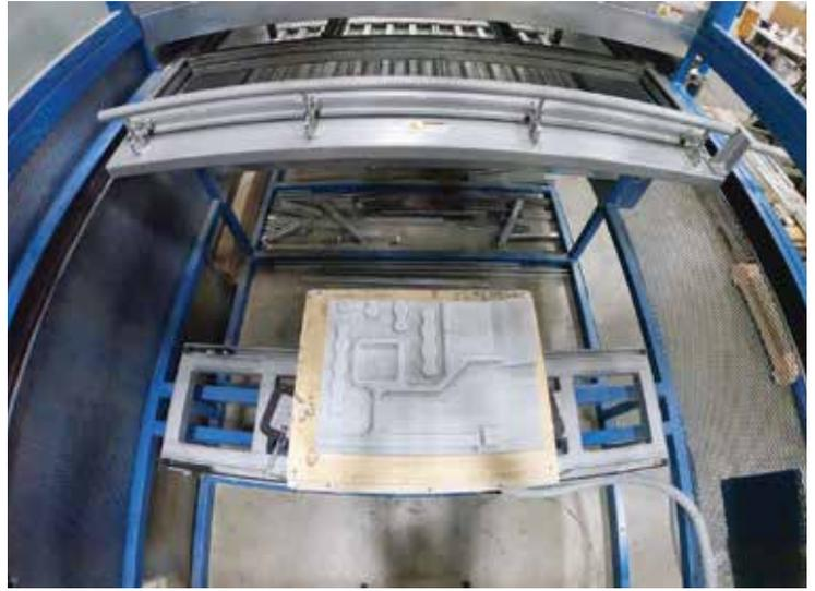
Massivit 3D 与 ACS Hybrid Inc. 和 3D Composites 合作, 在 Massivit 1800 Pro 上打印一个航空零件。(图片由 Massivit 公司提供)
