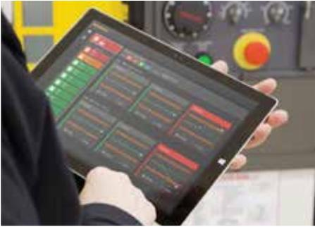
**Renishaw 的 Reporter 软件将测量数据输送到 Renishaw Central, 这是一个制造数据平台, 其中信息包括了机床状态、警报和来自机床测头和对刀仪、Equator 测量系统和坐标测量机的测量结果。(图片由 Renishaw 公司提供)**
