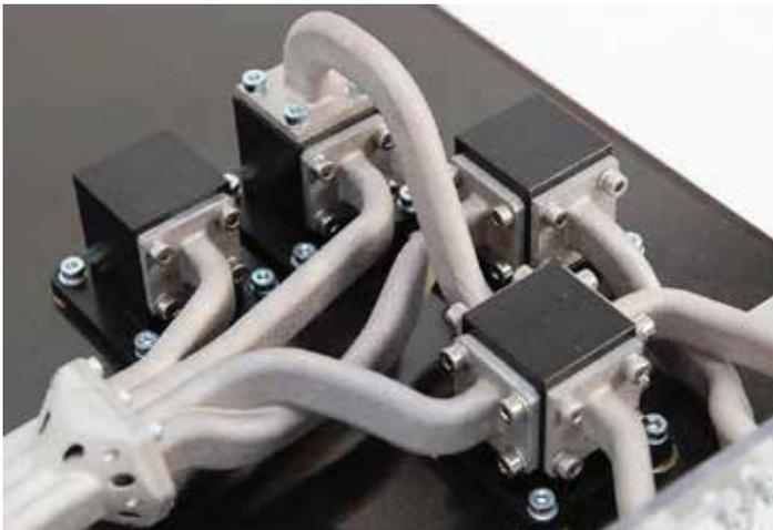
由多个波导合并组成的一个 3D 打印零部件。（图片由 Swissto12 公司提供）
