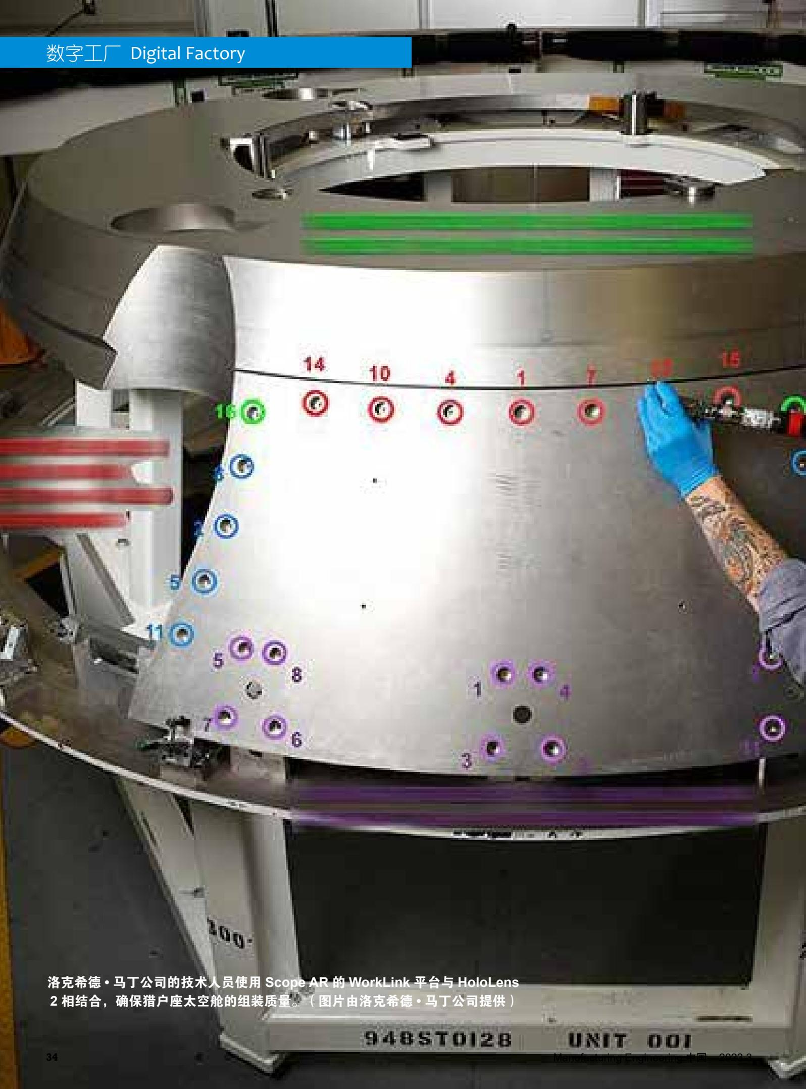
洛克希德·马丁公司的技术人员使用 Scope AR 的 WorkLink 平台与 HoloLens 2 相结合，确保猎户座太空舱的组装质量。（图片由洛克希德·马丁公司提供）
