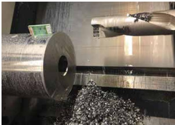
在 CMG 使用的可转位硬质合金刀片采用了 Tiger-tec Silver 涂层技术，旨在通过其优化的微观结构提高加工性能，同时减少残留和热应力磨损。
