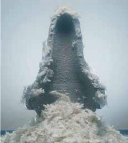
Massivit 3D 公司调整了其紫外线固化材料的化学成分，以帮助其在新的 3D 打印工艺中破水。该设计可用于该公司的 Massivit 10000 模型（也是新的），稍作改变的材料 Dimengel 50 则可以用于打印一个各向同性的复合材料模具的外壳。其外壳可通过水洗去除。（图片由 Massivit 公司提供）
