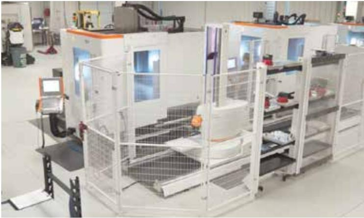
为了增加主轴的正常运行时间和生产的灵活性，Gray 加工技术公司从 GF 加工方案公司购买了两台五轴 MILL E 700 U 加工中心，位于一个自动化单元内，其中包括一个 System 3R Transformer 模块化机器人和一个 12 托盘的装载站。
