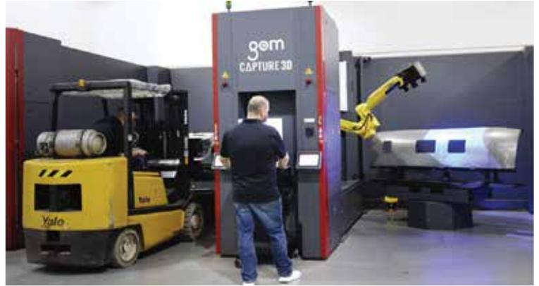
**Capture 3D 公司的 ATOS 全场扫描系统由 GOM 软件提供支持，由于 CAD 软件中使用了基于模型的定义，因此他可以自动感知要检查的内容以及如何确定一个部件是否在公差范围内。** (图片由 Renishaw 公司提供)
