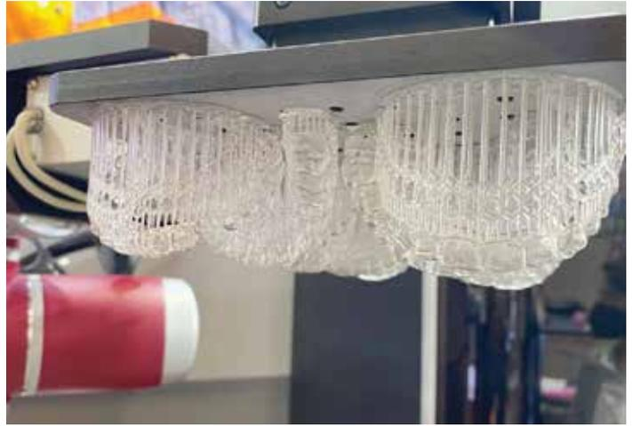
带有支撑结构的直接 3D 打印牙齿矫正器。（图片由 LuxCreo 公司提供）
