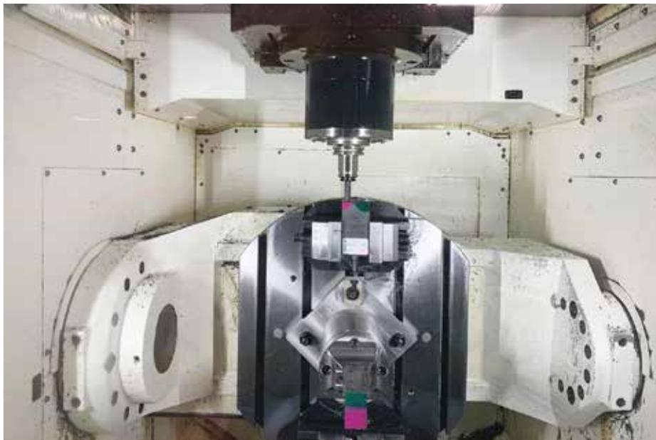
加工中心配备了 Sandvik Cormorant 刀具和定制的夹具，机床可以在 137IPM 下以 4500PM 的速度切割工具钢。（所有图片由 CNC 软件公司提供）
