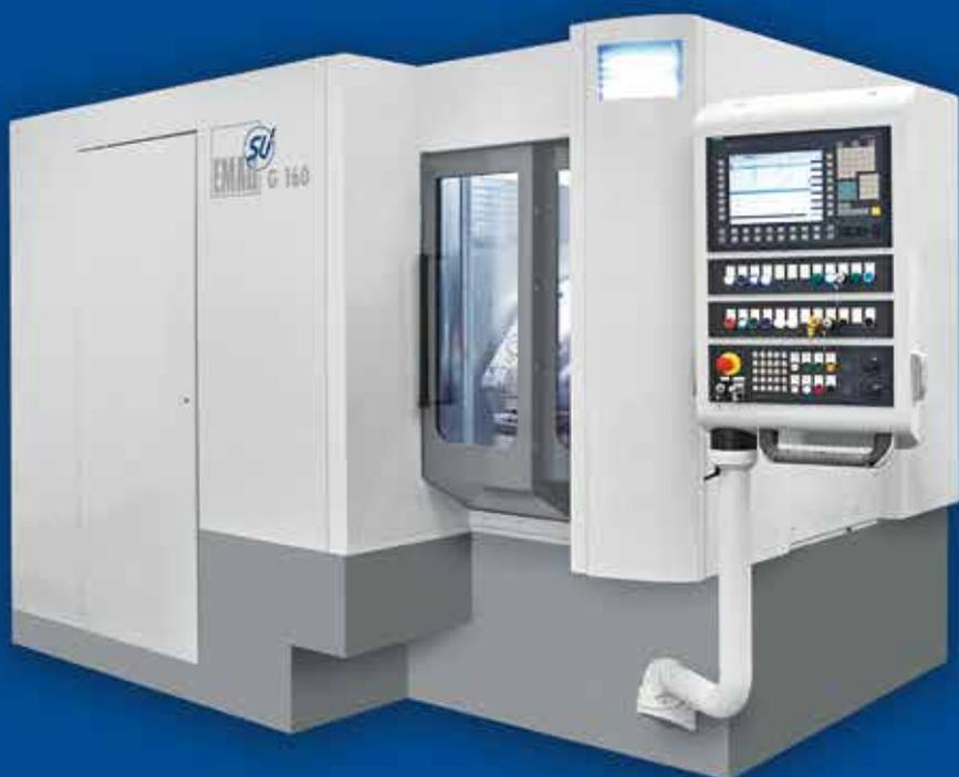
G 160 是双工位高效蜗杆砂轮磨齿机。适用于大批量齿轮的高精度高效稳定生产，双工位工件更换时间仅需1.5秒！切削速度80m/s
