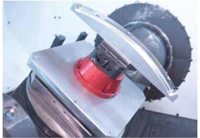
为了在其 MILL E 700 U 机床上实现五轴铣削的生产目标，Gray 加工技术公司在原始工件上战略性地留下了 0.005" - 0.010" 厚的标签，并将工件夹在一个能够加工所有零件特征的燕尾槽夹具中。
