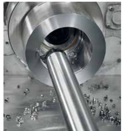
新的 Accure-tec A3000 镗杆及其减震系统，在加工长度 / 直径比超过  $6 \times D_c$  时表现出色。
