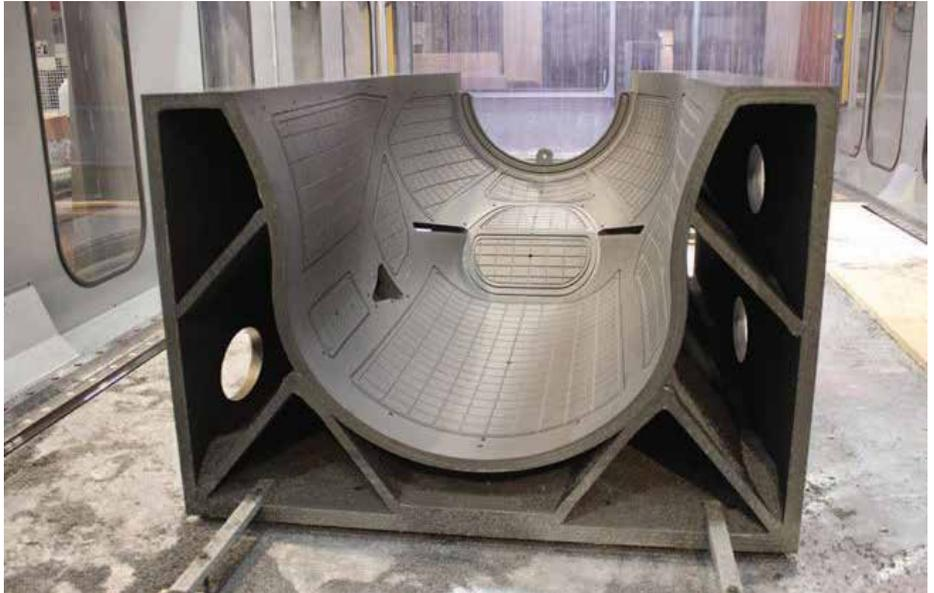
Thermwood 公司和 General Atomics Aeronautical Systems 公司在两种增材制造方法的正面比较中进行了竞争，以制造一个数控修整工具。Thermwood 在其 LSAM 1020 上使用 ABS 颗粒和 20% 的碳纤维填充物 3D 打印了该零件。这家航空航天公司说，与他们正在使用的传统手工铺设方法相比，节省了大约 5 万美元。（图片由 Thermwood 公司提供）
