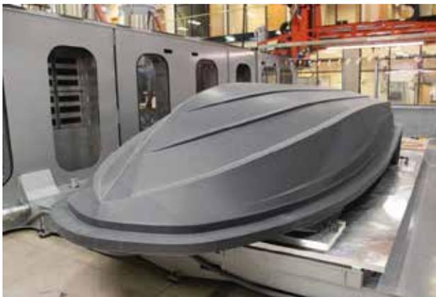
**Thermwood 公司用 Techmer Electrafil ABS LT1 3DP 为 White River Marine Group 3D 打印了一个船体模型。整个打印、组装和修整过程只需要不到 10 个工作日就能完成，并且仅使用了大约 15000 美元的材料。（图片由 Thermwood 公司提供）**
