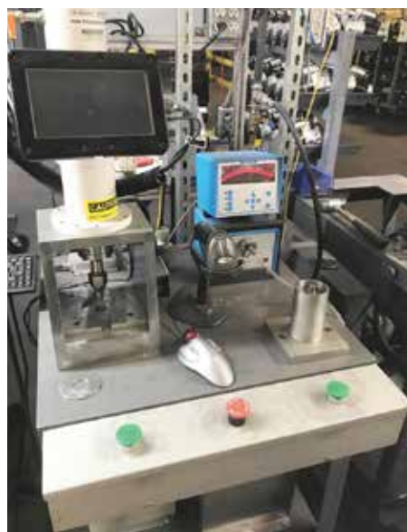
用于换向器端架的衬套压力机按照指定深度和力度安装衬套，并使用图示扫描仪记录员工编号、日期和批号。气动量规在安装后测量内径，并记录力、深度和内径测量值。
