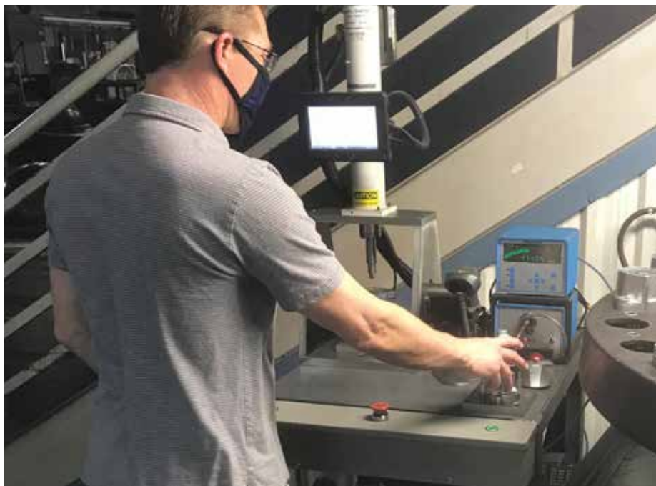
Daniel Anderson 正在操作 PPR 从 Promess 购买的机电装配压力机 (EMAP)。EMAP 使用伺服驱动的精密滚珠丝杠滑块，并配有力和位置传感器，可向控制器提供反馈。
