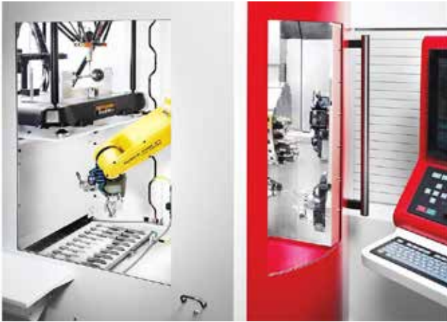
Index iX Center 自动化单元用于熄灯生产，利用托盘系统进行材料管理，并利用 FANUC 机器人将零件传送到雷尼绍量具或坐标测量机。(由 Index 公司提供)
