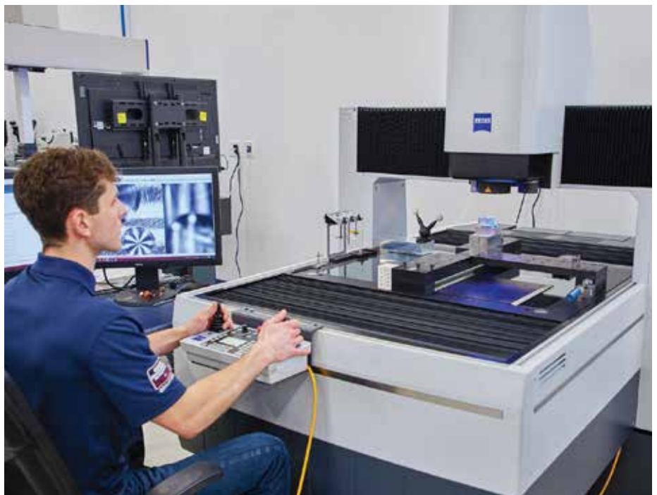
Zeiss 的 O-Inspect 系统包括多个传感器，其中有几个接触式传感器和一个摄像头，以便在几乎无需操作部件的情况下检测表面细节。(图片由 Zeiss 提供)
