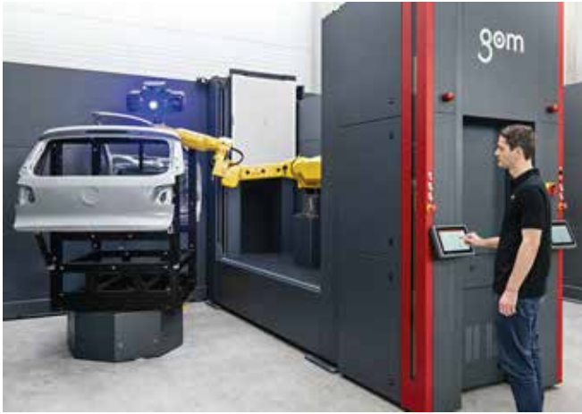
ATOS ScanBox 自动机器人 3D 扫描和检测系统可以扫描从模具到零件生产的整个过程，从而创建数字资产。（图片由 GOM 公司提供）
