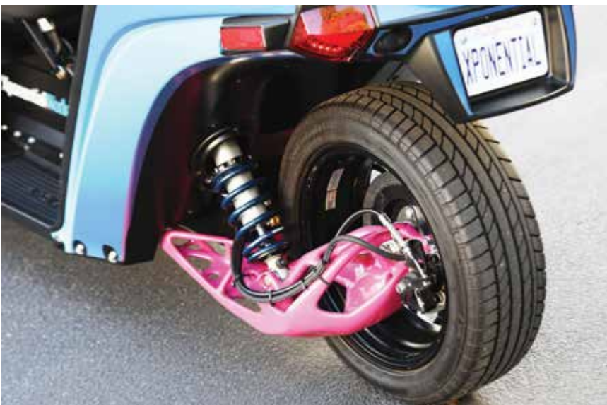
Arcimoto Fun Utility Vehicle 的后摇臂是通过树脂 3D 打印模型铸造的。（图片由 Nexa3D 提供）
