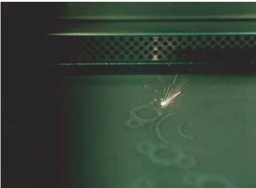
Stratasys Direct Manufacturing 位于德克萨斯州奥斯汀的工厂正在进行 DMLS 3D 打印。（由 Stratasys 提供）
