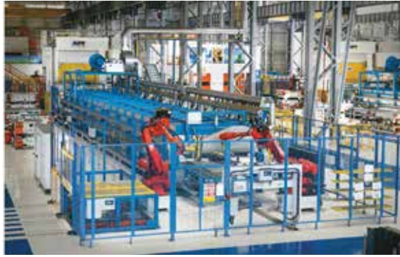
由 AP&T 在 2007 年至 2008 年期间交付的冲压淬火生产线，现在的生产能力比安装时更高。
