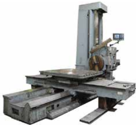
如今的 DRO 系统在与大多数全新手动加工中心配套使用的同时，也使传统系统实现了现代化。(由 Fagor Automation 公司提供)
