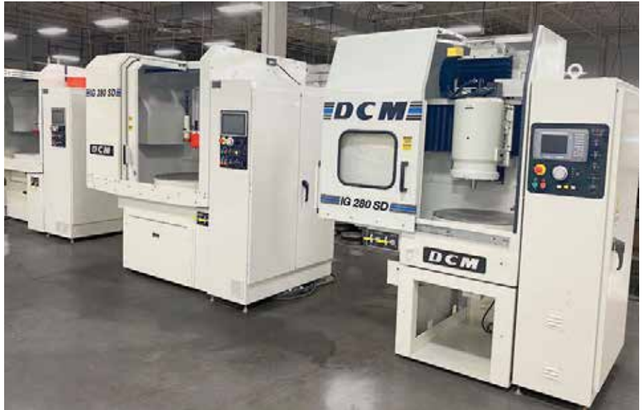
DCM Tech 公司的 IG 系列旋转平面磨床提供变速工作台和变速磨削主轴电机。
