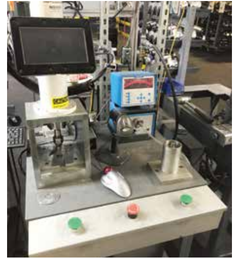
用于换向器端架的衬套压机将衬套以指定的力安装到指定的深度上，并使用所示的扫描仪记录员工编号、日期和批号。空气量则在安装后测量内径，并记录力、深度和内径测量值。
