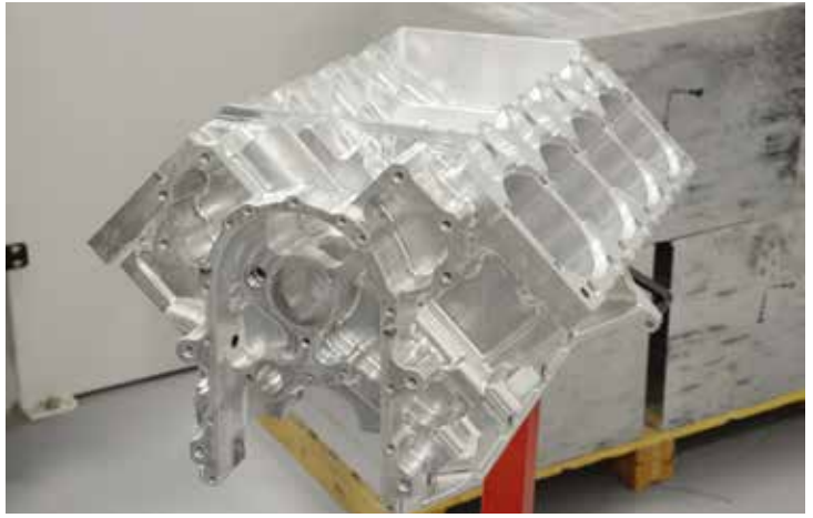
在 Don Schumacher 车队中制造的一个发动机组。它起初是一个 800 磅的铝制品，通过使用高速动态加工和 Opti-Rough 刀具路径来粗加工复杂的几何形状，将其加工到 140 磅。
