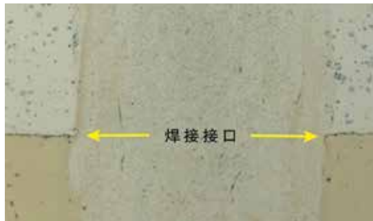
左图 5a: Haynes 230 + Waspaloy; 采用脉冲整形的搭接接头; 焊缝根部没有界面裂纹或气孔。
