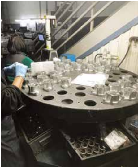
操作员将驱动零件安装到旋转缓冲台的框架中，这是在两个 EMAP 冲压站之间的生产步骤。
