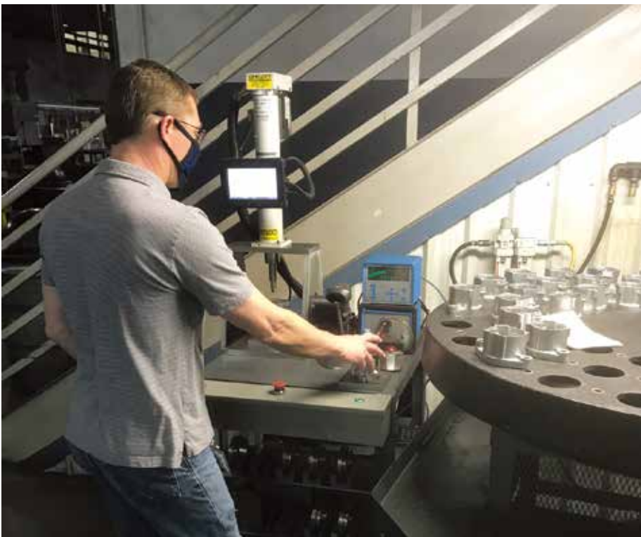
Daniel Anderson 在操作 PPR 的机电装配压机（EMAP）。EMAP 使用一个伺服驱动的精密切滚珠丝杠滑块，并拥有力和位置传感器向控制器提供反馈。 (所有图片由 Precision Parts & Remanufacturing 公司提供)
