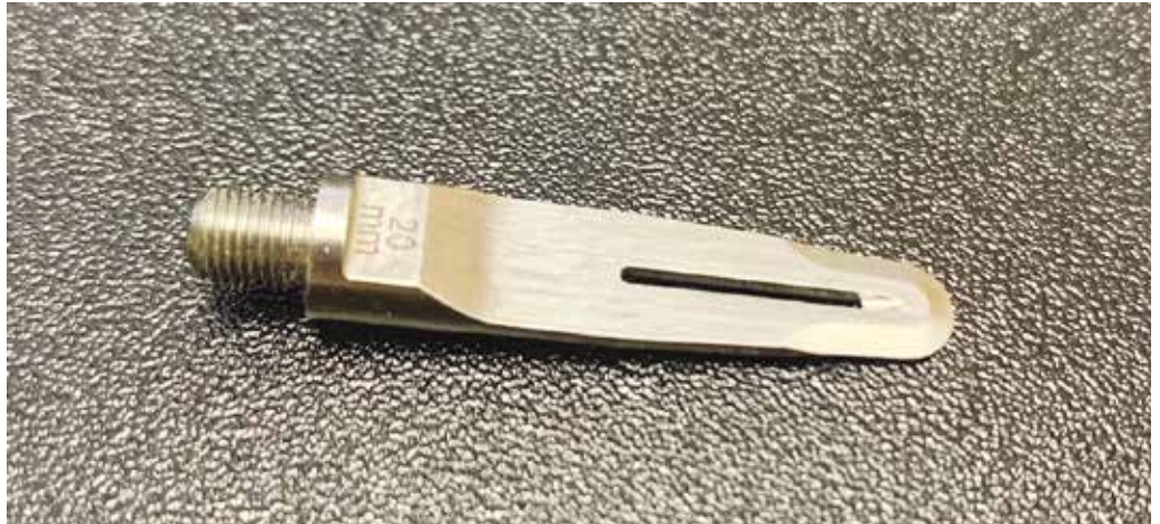
在 Swissline Precision 公司，加工钛合金超声波手术刀（如图）对冷却液提出了挑战，但在安装了 Purge 系统后，该公司每个周末获得了额外 42 小时的无人操作。（图片由 Swissline Precision 公司提供）
