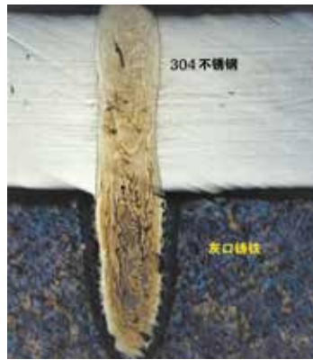
图 3: 2 毫米厚的 304 SS + 4.5 毫米厚的灰铸铁; 搭接接头; N2 保护气; 带脉冲整形。
