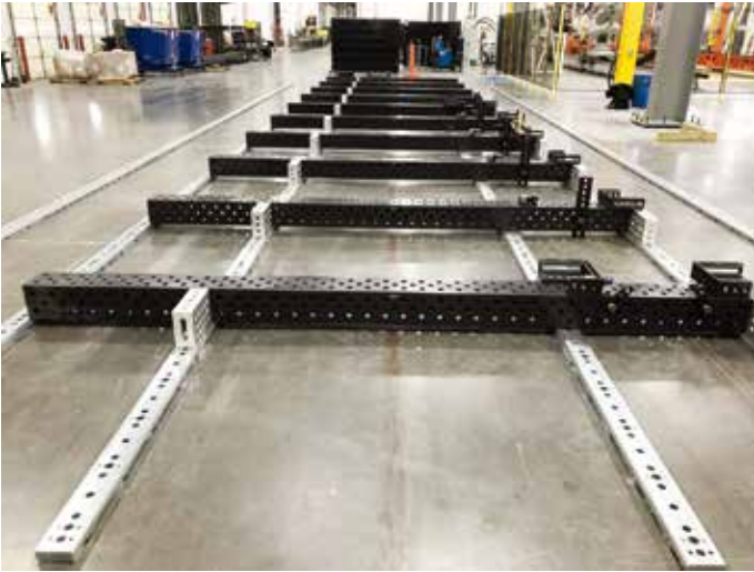
需要定制部件来支撑 U 型结构。控制台块是一个临时的解决方案，允许系统立即投入使用。
