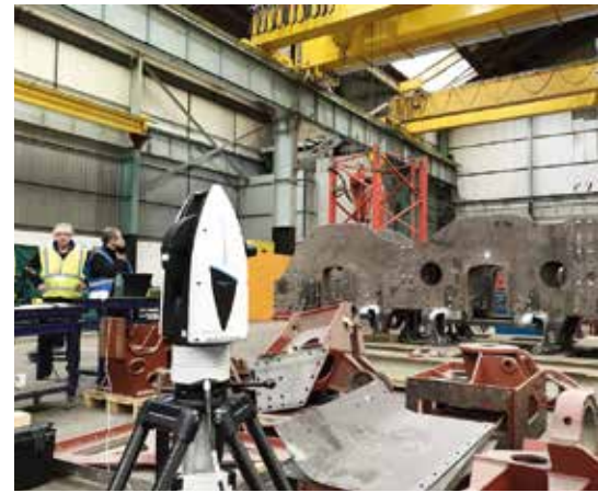
Leica Absolute Tracker ATS600 可以轻松扫描超大型零件，具有计量级的精度。
