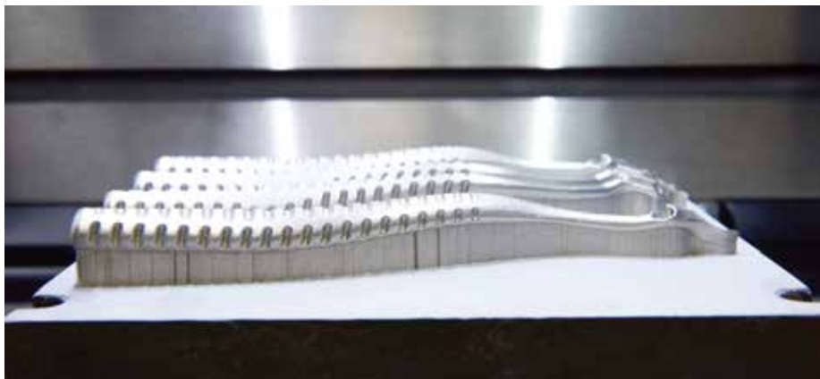
Pathfinder 的特点是其形状能够改变，以配合膝关节的解剖结构。 (图片由 Stratasys Direct Manufacturing 提供)
