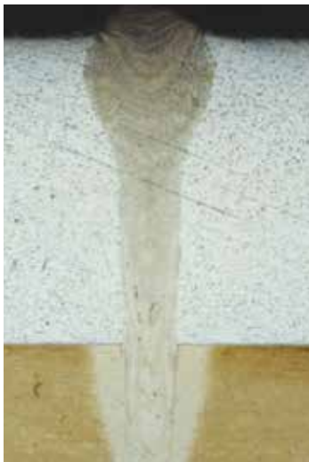
左图 5a: Haynes 230 + Waspaloy; 采用脉冲整形的搭接接头; 焊缝根部没有界面裂纹或气孔。
