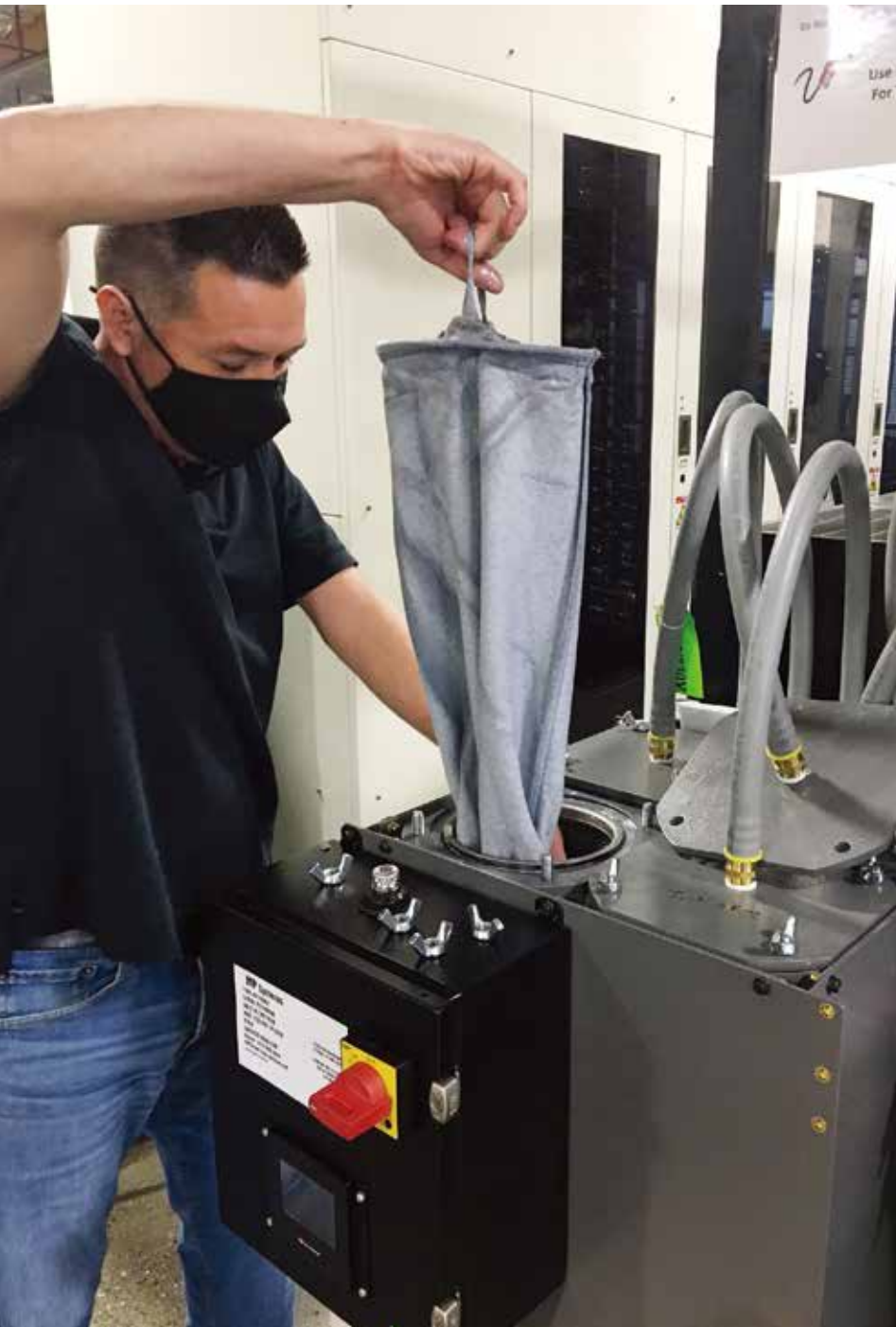
在卸下四个蝶形螺母后，Micro-Mechanics 公司的制造技术部门经理 David Vaca 展示了从净化装置中卸下脏过滤袋的过程。
