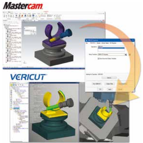
这里显示的是 Mastercam CAM 软件与 CGTech 公司的 VERICUT 刀具路径仿真和优化软件的互用性。(图片由 CGTech 公司提供)
