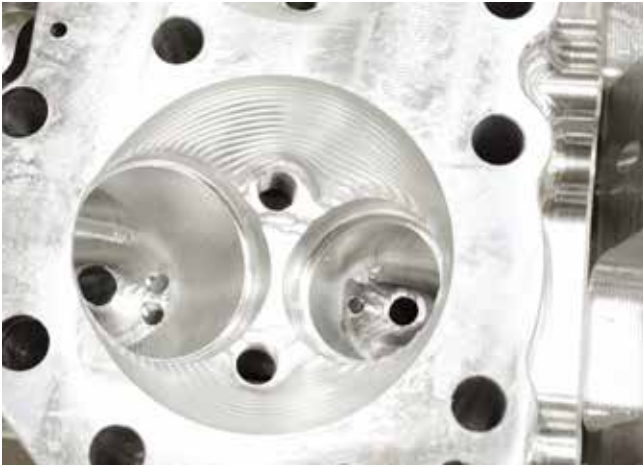
操作员 Frank Cervelli 正在 Okuma MU6300V 上加工发动机组。在这里，他把 Hemi heads 安装到机器上。
