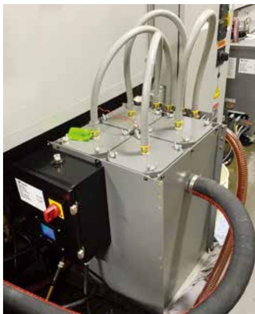
在 Swissline Precision 公司，一个 Purge 过滤装置安装在 Tsugami Swiss-turn 机床后面。（图片由 Swissline Precision 公司提供）
