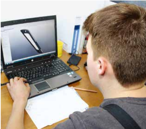
Len Kodlin 在一个外部 CAD/CAM 工作站为许多自行设计的部件创建数控程序。图中是一个由铝制成的装饰性部件
