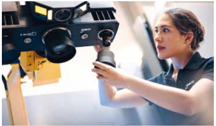
在 GOM 的自动测量机中，ATOS 传感器可以与 Plus Box 一起操作，Plus Box 是一种摄影测量的附加传感器，可以直接连接到 ATOS 系统上。（图片由 GOM 美洲公司提供）
