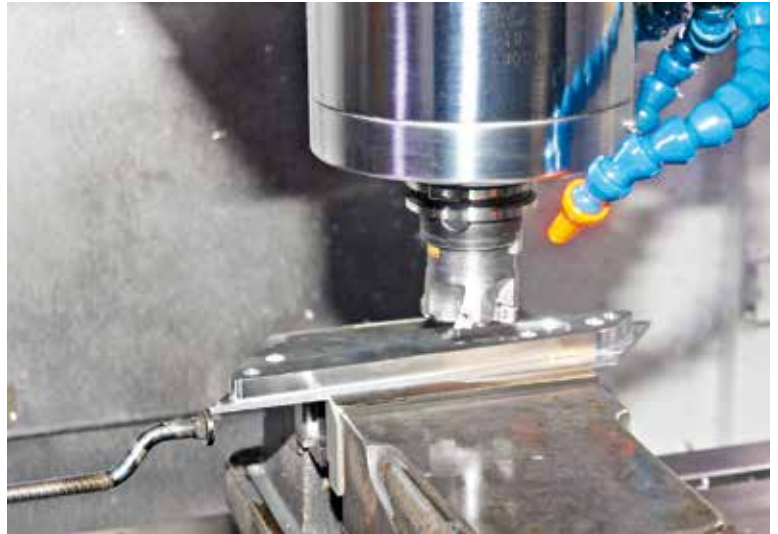
使用 MMD Werkzeugmaschinen 公司的 PreMill VL 1000 数控加工中心加工一个零件，配备 Sinumerik 828D 数控系统。一个 10kW 级的铣削主轴能够快速而精确地加工零件。
