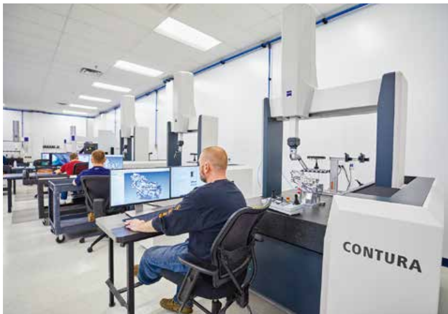
一排 Zeiss 多传感器 CONTURA 三坐标测量机。用户以一个套餐价格获得软件、附件、计算机和安装。（图片由 Zeiss 工业质量解决方案提供）
