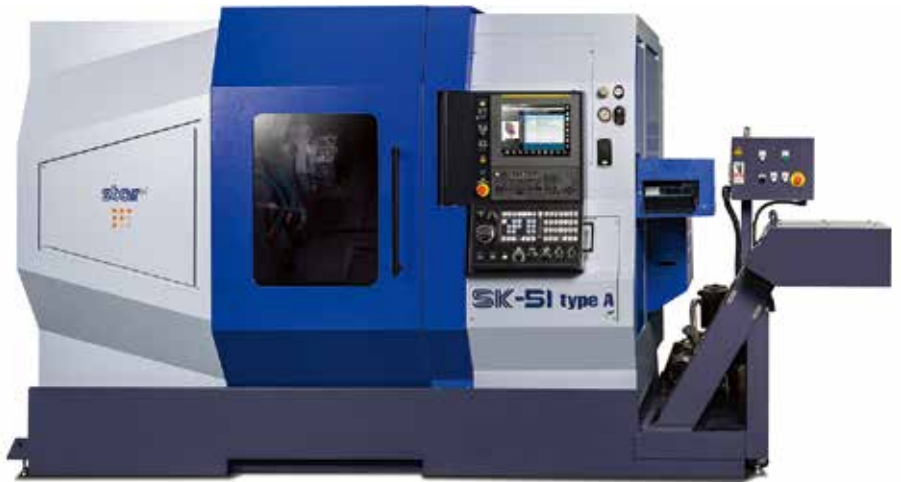
Star 公司的 SK-51 型 A 型数控瑞士自动车床配备了 FANUC 的 iHMI 控制，提供了易用性和先进的图形化显示。（图片由 Star 公司提供）
