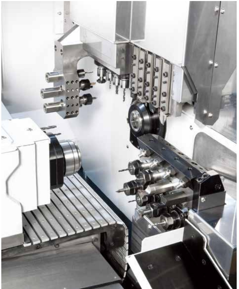
Absolute Machine Tools 的八轴 Nexturn PYII 系列有第二个 Y 轴，算上 8 把副主轴刀具在内，最多可容纳 27 把刀具。额外的刀具选项允许在主轴和副轴上使用更大的刀具库，从而加工出更为复杂的几何形状。（图片由 Absolute Machine Tools 公司提供）
