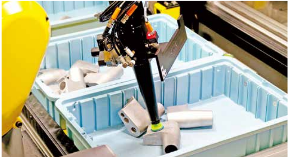
尽管这些锻造的铝制焊炬体排列随意，几何形状复杂，但 FANUC 的 iRVision 系统能够确定机器人的方向，并将它们从物料箱中取出，然后装入 RoboDrill 进行加工。（由 Methods Machine Tools 公司提供）
