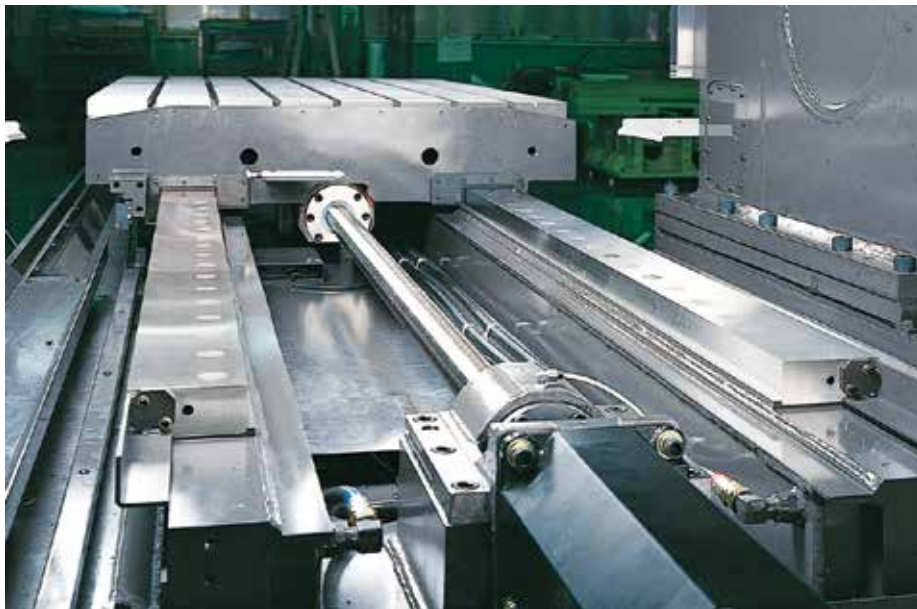
这台来自 YASDA 的 1218V 桥式加工中心的特点是具有精确研磨的导轨，并将其固定在了手工刮削的安装表面上。（图片由 Methods 机床公司提供）
