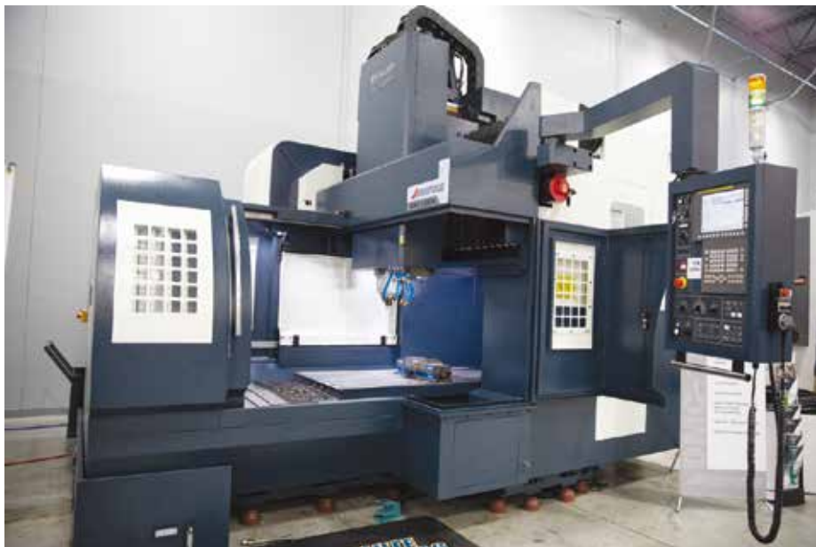
一些机床厂主说，在体验了桥式铣床改进的人机工程学、较低的维护成本和整体刚性之后，他们再也不会回过头来重新选择C型框架机床了，图中Absolute Machine Tools的这台Johnford机床就是一个例子。（图片由Absolute提供）
