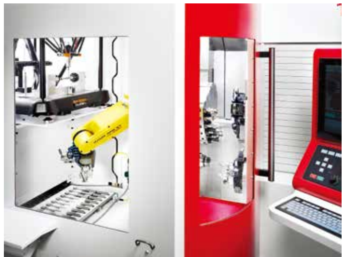
Index iX Center 自动化单元可用于熄灯生产。在生产中该设备配有托盘系统进行材料管理，并可以通过 FANUC 机器人将零件传递给 Renishaw 的量仪或 CMM。（图片由 Index 公司提供）
