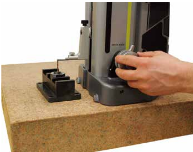
切削刀具的离线测量不需要任何特殊设备，如本例中使用 National Machine Products 公司的预设块即可完成。（图片由 Tsugami/REM Sales 公司提供）
