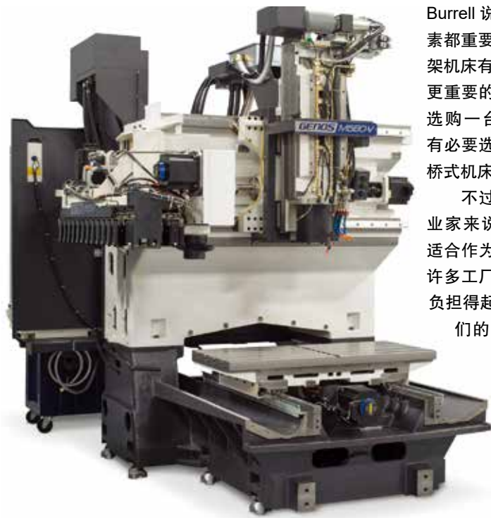
这台Okuma GENOS M560V，去掉了金属板和控制器，向人们展示了立式加工中心的桥式结构。（图片由Okuma美国公司提供）
