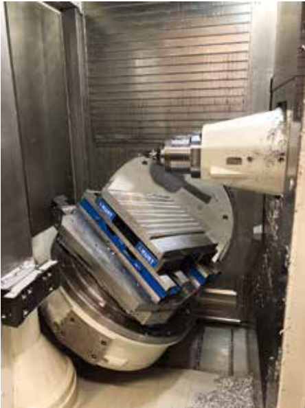
Grob G751 5轴机床在工作台上有两个旋转轴，可以倒置加工像发动机部件这样的零件。
